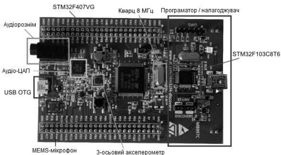
Рисунок 2.3 – Призначення компонентів STM32F4Discovery
