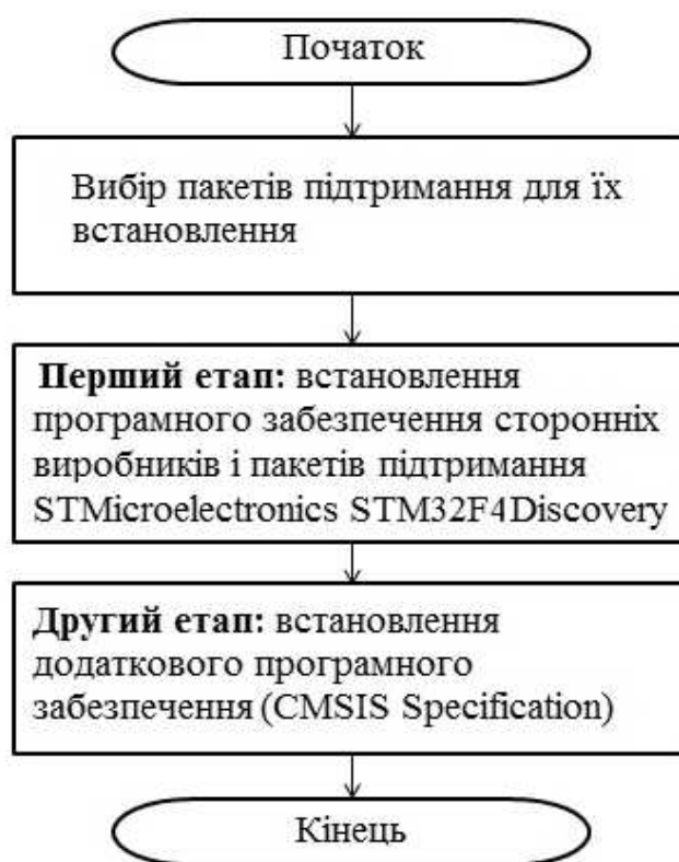
Рисунок 7.1 – Алгоритм налаштування Matlab Simulink для програмування мікроконтролера STM32F4discovery
