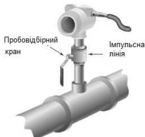
Рисунок 2.32 – Схема монтажу датчика з пробовідбірним краном, відсічним вентилем, установленим на короткій імпульсній лінії
