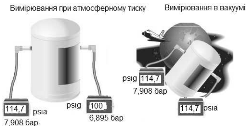
Рисунок 2.30 – Різниця при вимірюванні абсолютного й відносного тиску
