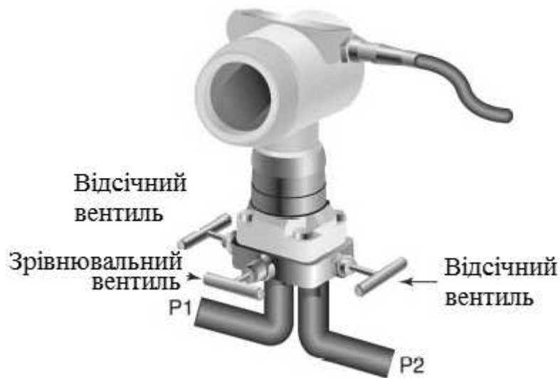
Рисунок 2.33 – Схема монтажу диференціального датчика тиску з вентильним блоком
