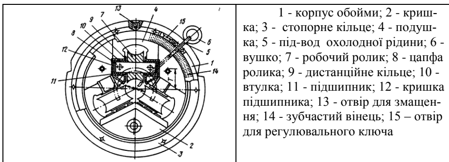
Рисунок 3.19 - Конструкція роликової обойми рейкового стану
