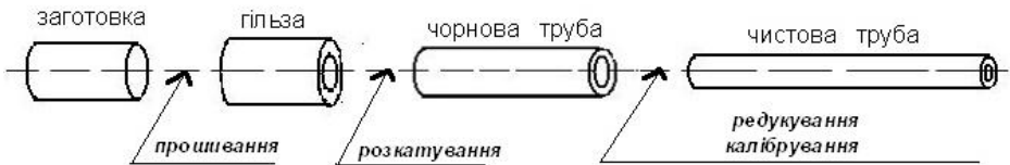
Рисунок 1.2 - Технологічна послідовність виробництва гарячекатаної безшовної труби
