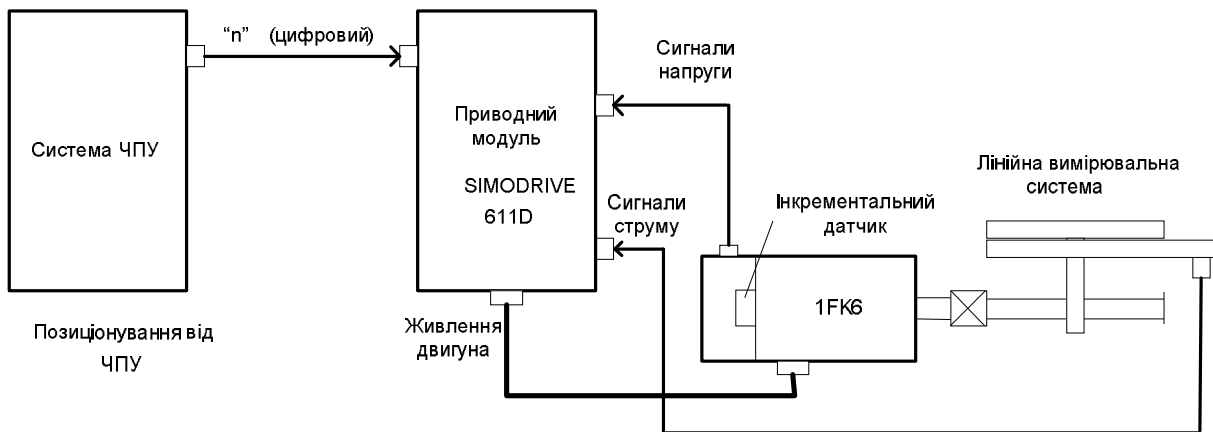
Рисунок 6.12 – Цифрове керування приводом подачі із прямою реєстрацією положення
