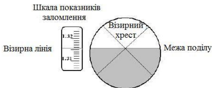
Рисунок 2.6 – Поле зору об'єктива рефрактометра
