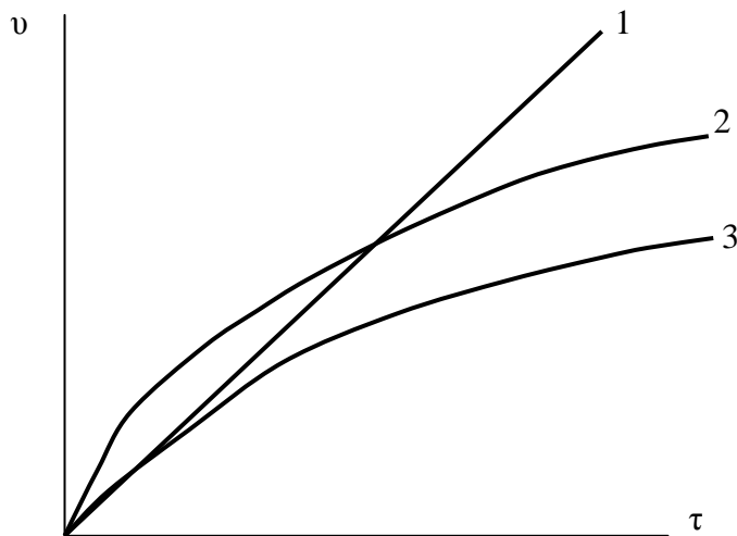
Рисунок 6.1 Кінетика високотемпературної газової корозії при лінійному (1), параболічному (2) і логарифмічному (3) законах росту плівки продуктів корозії
