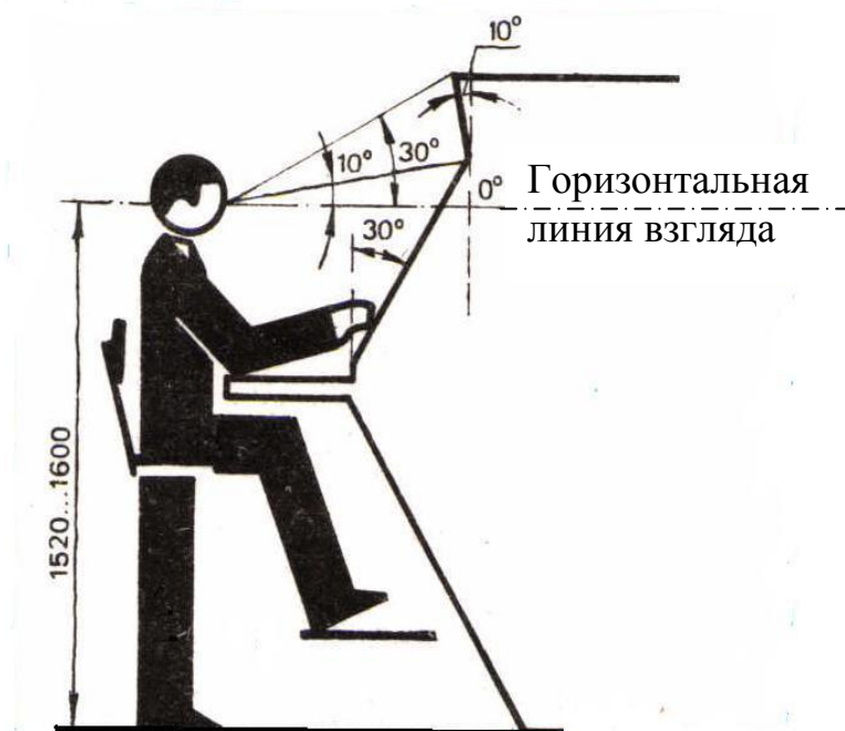
Рисунок 18 – Расположение и углы наклона панели пульта управления для рабочего положения «сидя-стоя»
