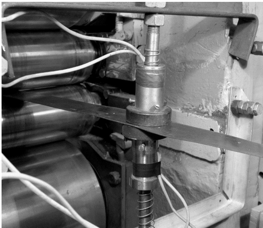
Рис. 1.8. Загальні види установки вимірювачів температури робочих валків (а) і смуги (б) при її прокатці на промислово-лабораторному реверсивному стані 105/260×250 ДДМА
