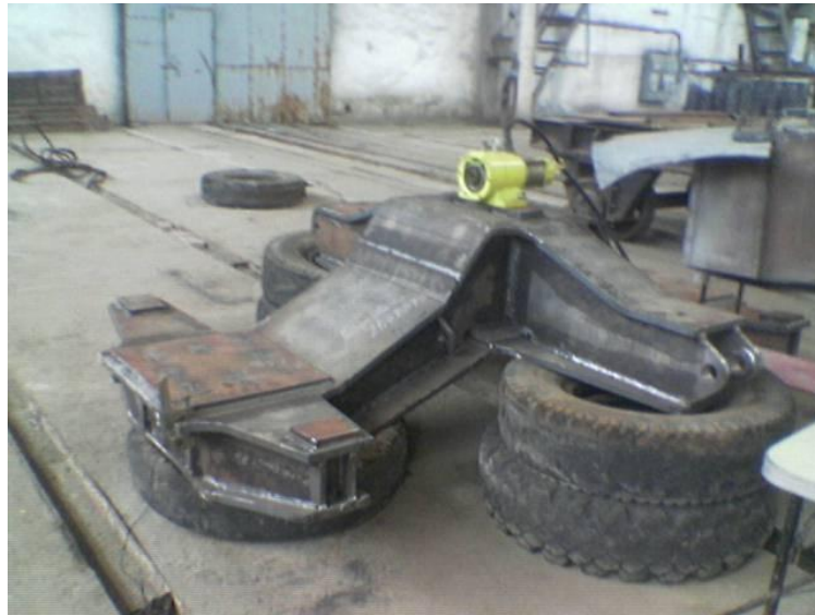
Рис. 6.5. Балансир с закрепленным вибратором
