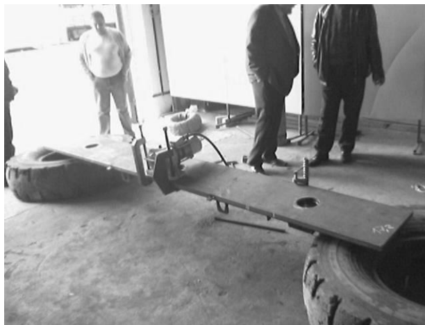
Рис. 4.8.- Конструкция с закрепленным вибратором на опорах
