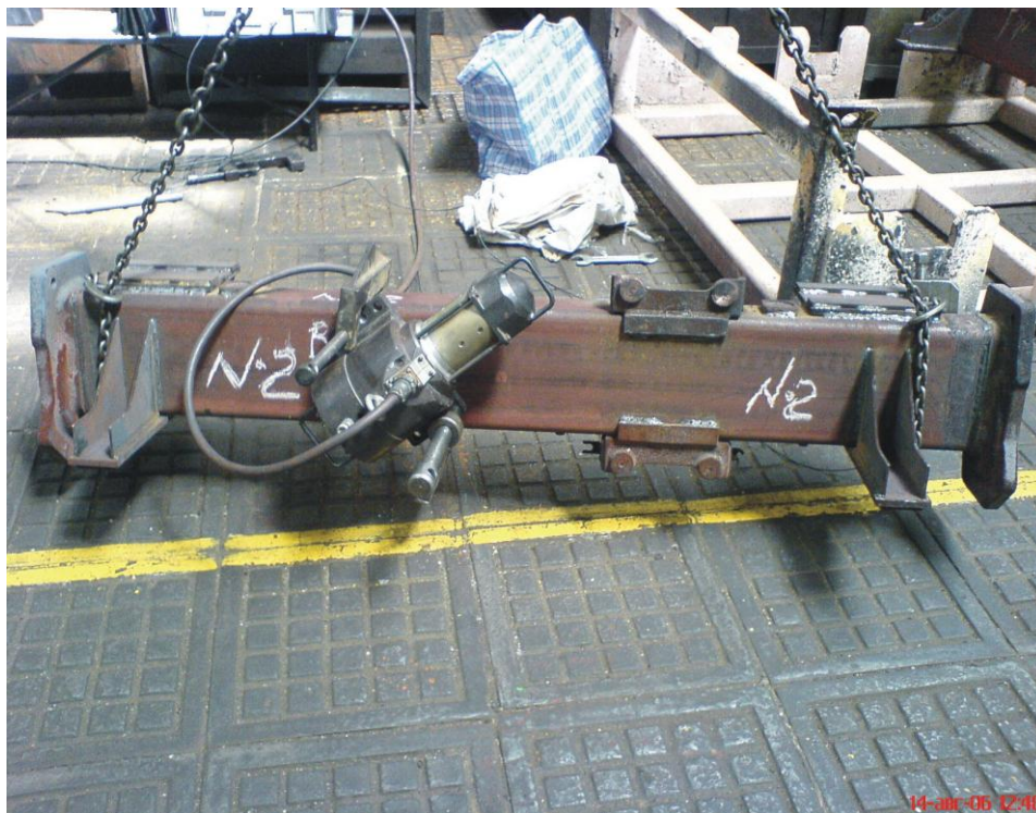
Рис 6.8 Изделие «Балка моста» с закрепленным виброблоком
