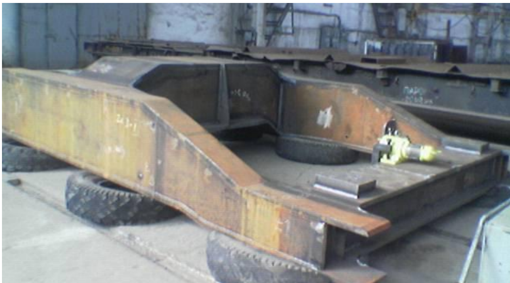
Рис. 6.2. Закрепление вибратора на конструкции
