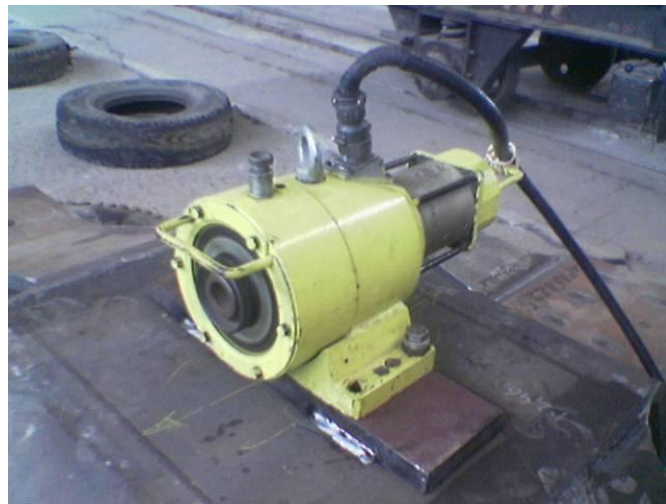
Рис. 6.6. – Крепление вибратора к конструкции
