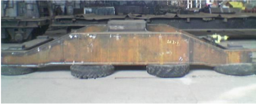
Рис. 6.1. Большой балансир после установки на опоры
