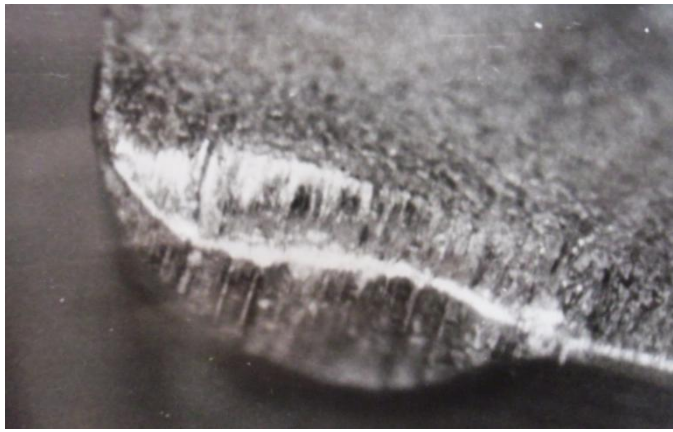
Рисунок 2 – Вигляд зносу при точінні сплаву ХН67МВТЮ інструментом з твердого сплаву ВК6М при швидкості різання V = 1,1 м/с ( S_o = 0,11 мм/об, t = 0,5 мм, МОР: 5 % МХО-64а, час роботи - 4,5 хв)
