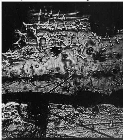
Рис.2. Мікроструктура дифузійного шару на сталі 45 з попереднім Ni–Co–P покриттям за рецептурою №2.
