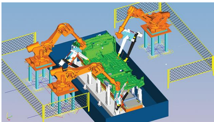
Рисунок 2 – Перегляд інженерних процесів з метою створення «сучасного» заводу в програмному продукті FactoryFlow
