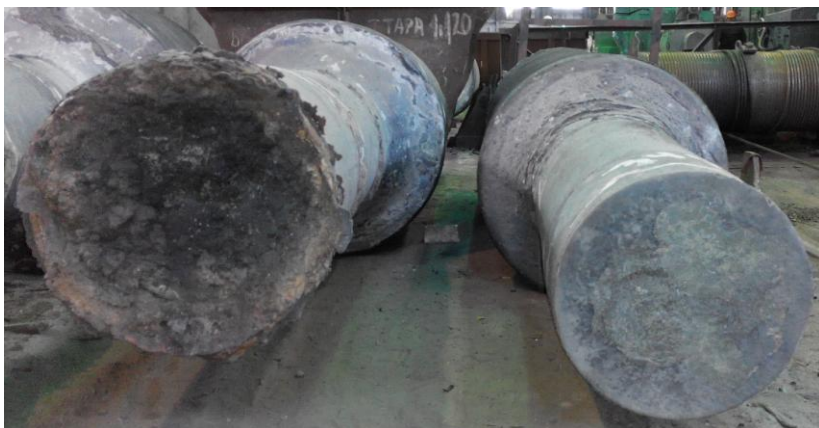
Рис. 1. Торец прибыли валка из стали 150ХНМ после ЭШО и валка, отлитого с утеплением прибыли экзотермической смесью и двухразовой доливкой расплавом
