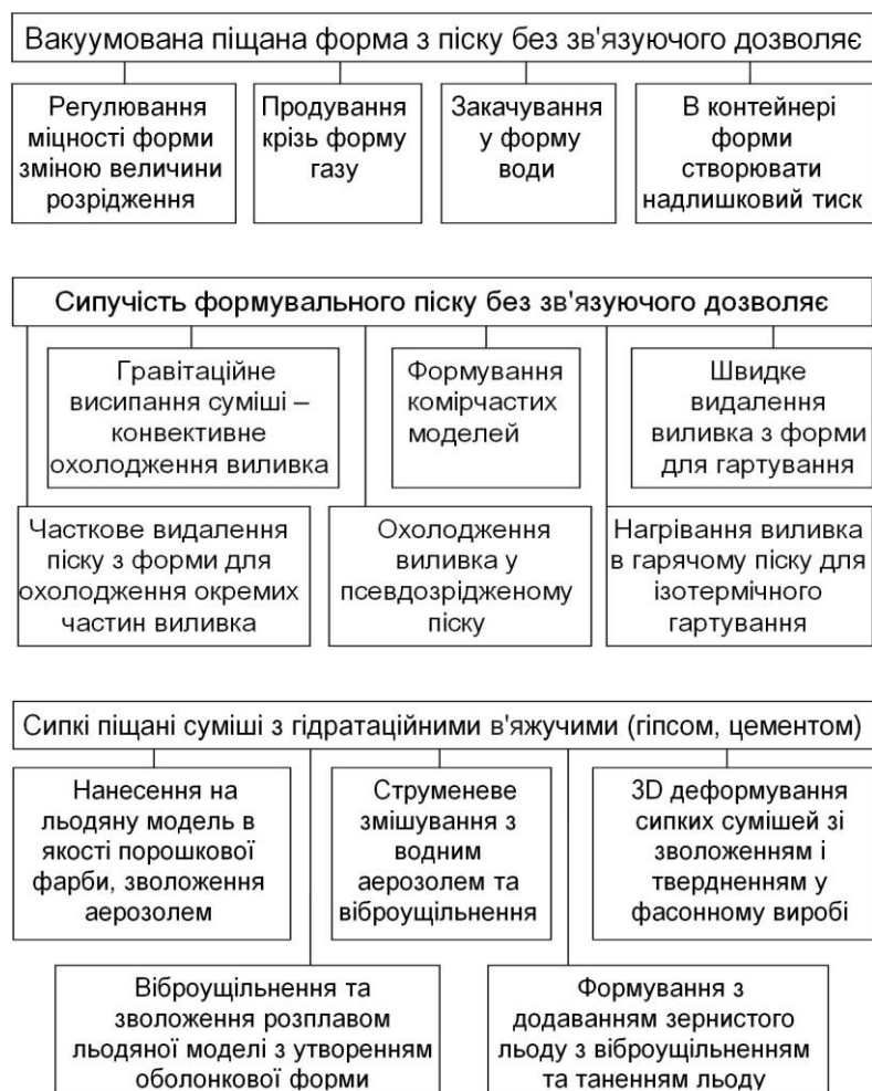
Рис. 1. Можливості сипких суміші і піску у формі
