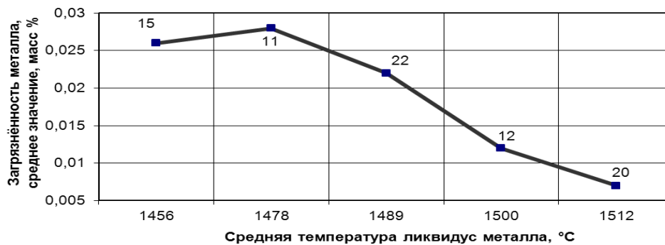
Рис. 1. Загрязненность металла неметаллическими включениями в зависимости от температуры ликвидус.
