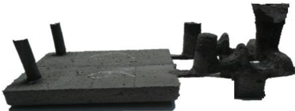
Рис. 2. Внешний вид экспериментальной отливки с литниково-модифицирующей системой
