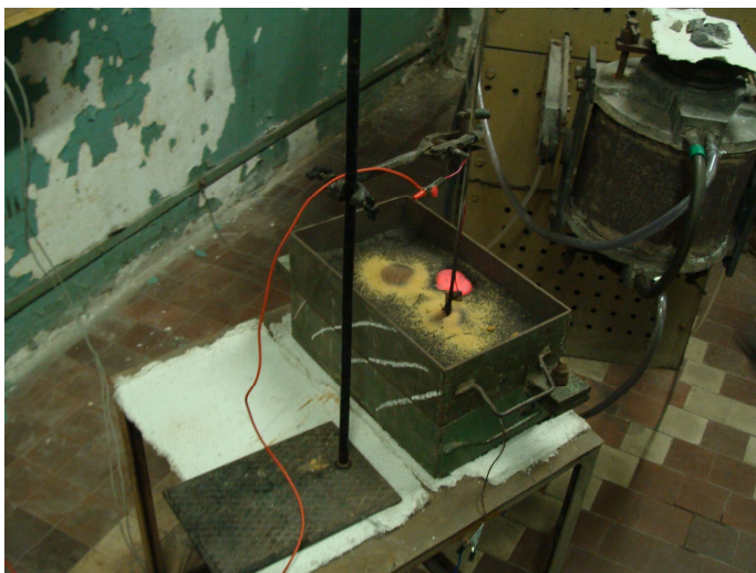
Рис. 1. Фото ливарної форми з підключеними до неї електродами
