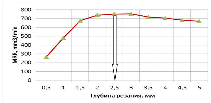
Рисунок 1 – График зависимости оптимальной MRR от глубины резания
