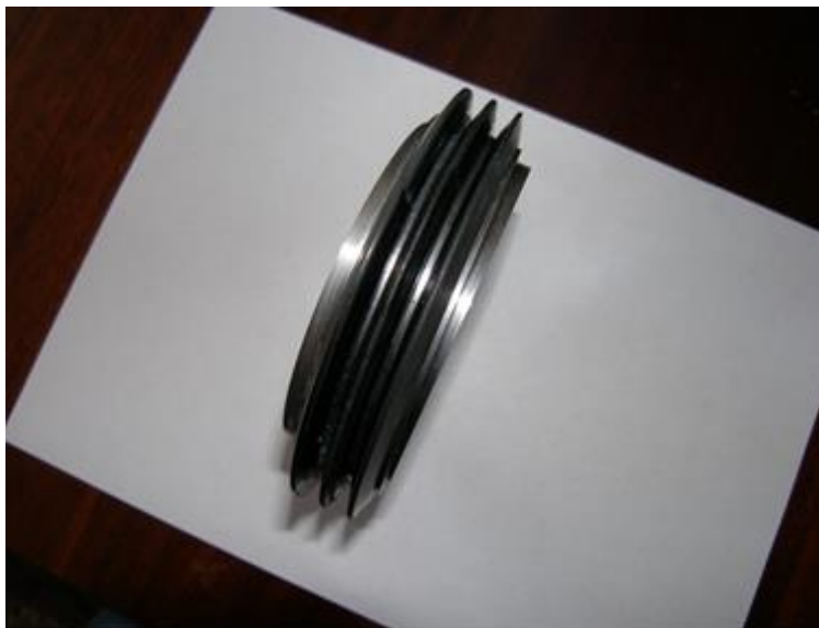
Рисунок 1 – Алмазний еластичний черв'ячний хон з профілем архимедова черв'яка
