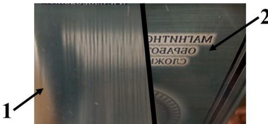
Рисунок 2 – Зовнішній вигляд поверхні плоскої деталі зі сталі 45 1 – після шліфування, 2 – після MAO
