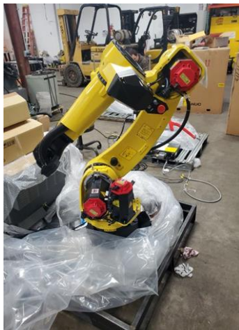
Рисунок 1. Промисловий робот FANUC M-20iD для переміщення та обробки металевих деталей
