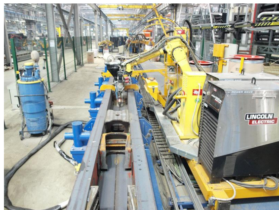
Рисунок 8. Зварювальні лінії побудовані за агрегатно — модульним принципом зі зварювальними роботами
