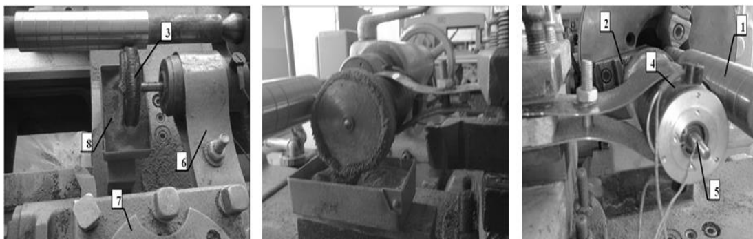
Рисунок 1. Експериментальна установка для проведення електромагнітно-абразивної обробки [2]. 1 – заготовка; 2 – патрон ГОСТ 2675-80; 3 – барабан з магнітом \varnothing 75 мм; 4 – двигун постійного струму (ДПС); 5 – струмознімач; 6 – тримач; 7 – різцетримач; 8 – тара з абразивом та Al порошком
