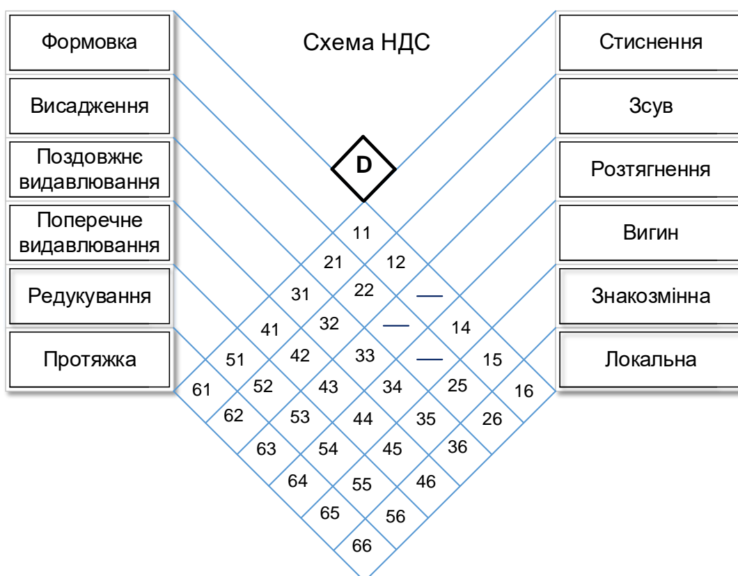
Рис. 2.1 – Аналіз можливих комбінацій технологічних схем і факторів (аркуш 2)
