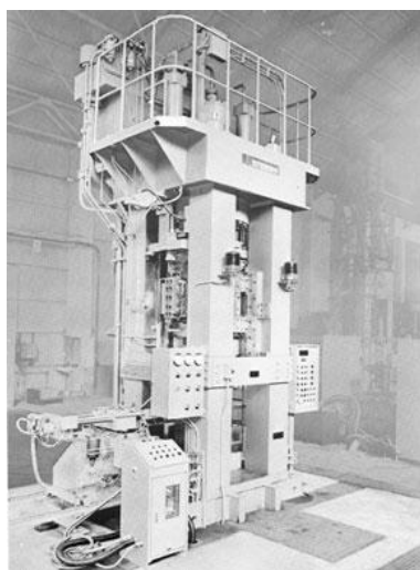
Рис. 1.30 – Схема пантографу (а), деталі (б) і загальний вигляд пресів для бокового видавлювання з двосторонньою подачою металу (в)
