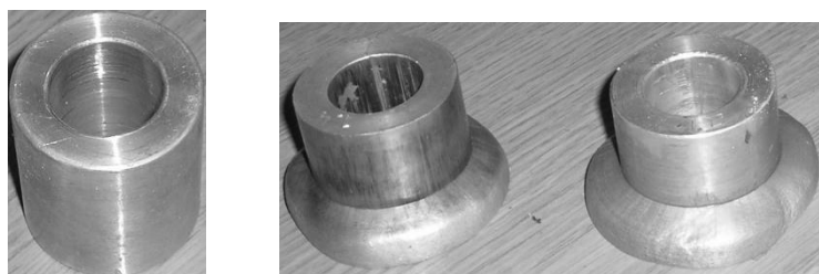
Рис. 7.67 – Заготовка і деталі для дослідження контактного тертя
