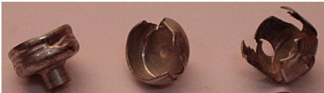
Рис. 6.37 – Деталі, зруйновані при радіально-прямому видавлюванні
