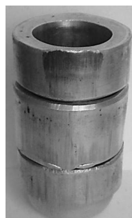
Рис. 7.46 – Комплект втулок після наскрізної прошивки
