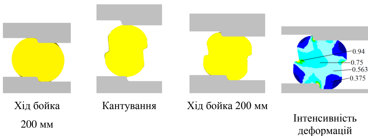
Рис. 7.49 – Поля розподілу інтенсивності деформацій в заготовці при деформації бойками з різною висотою уступу (перекриття дорівнює нулю)
