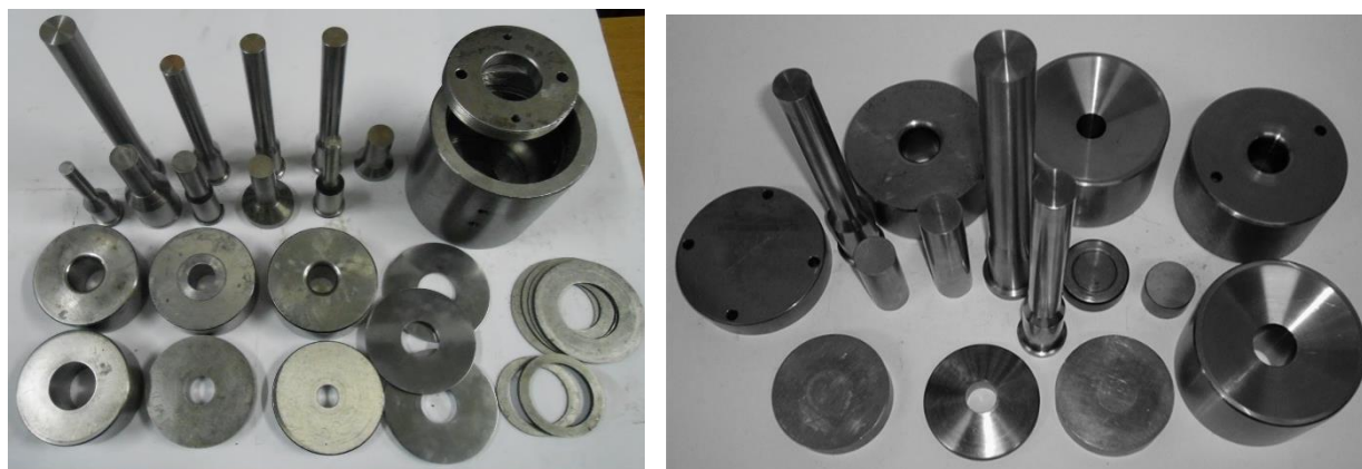
Рис. 2.18 – Змінний технологічний інструмент до експериментальних штампів
