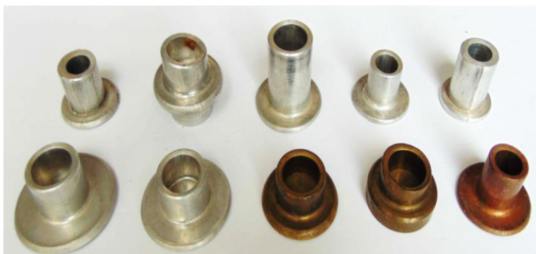
Рис. 5.18 – Деталі, виготовлені радіально-зворотним видавлюванням
