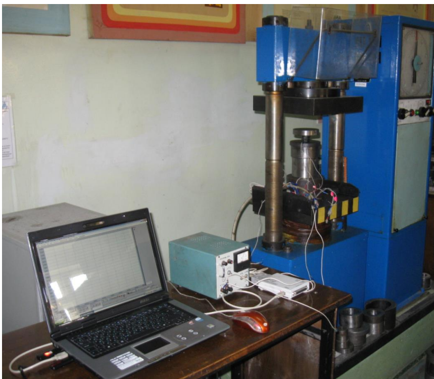
Рис. 2.10 – Схема експериментального стану на базі випробувальної машини МС500, АЦП, тензометричної апаратури і ПК
