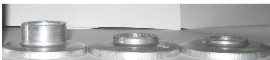
Рис. 7.35 – Деталі, що отримані радіальним видавлювання з протитиском
