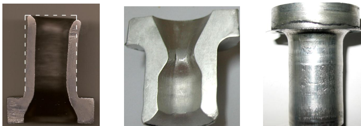
Рис. 7.13 – Дефекти у вигляді викривлення відростка і складок у процесі радіально-прямого видавлювання з обтисненням
