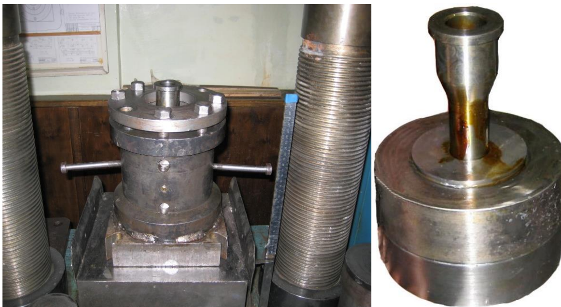
Рис. 2.17 – Технологічне оснащення для дослідження процесів холодного комбінованого видавлювання
