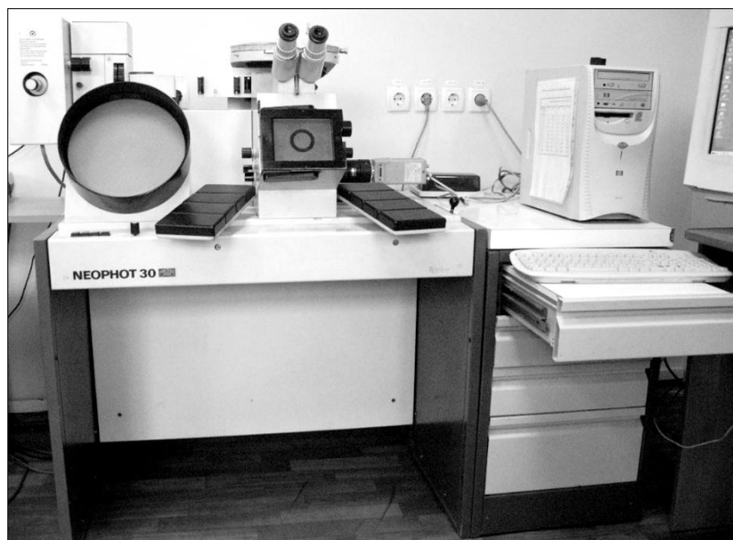
Рис. Г.3 – Великий фотомікроскоп відбитого світла «NEOPHOT 30»
