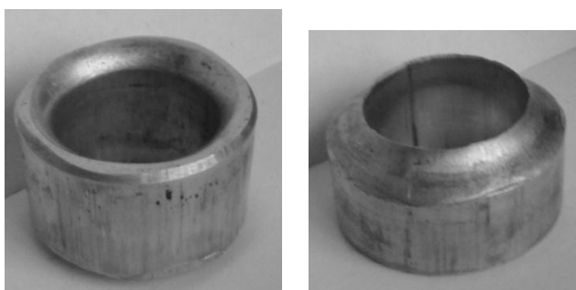
Рис. 7.45 – Дефект типу утягнення, який отримано на торцях втулки
