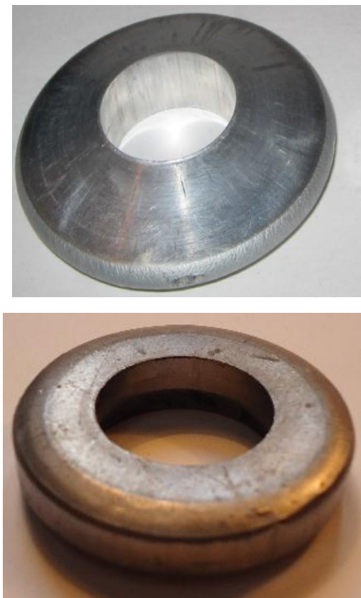
Рис. 7.41 – Деталі типу кільце, отримані при радіальному видавлюванні з зануренням пуансона в тіло фланця
