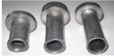
Рис. 6.42 – Деталі, отримані радіально-прямим видавлюванням з обтисненням
