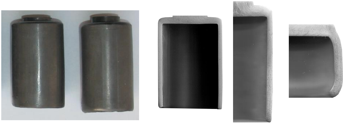
Рис. 6.36 – Деталі типу гільз і чашок, виготовлені радіально-прямим видавлюванням з роздачею
