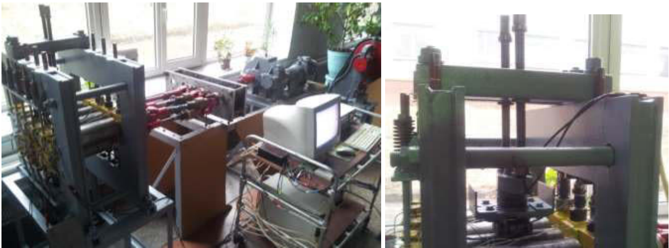
Рисунок 9 – Загальний вигляд листопрямуючої машини (а) і спеціального пристосування для диференційованого додатку сили до ролика листопрямуючої машини (б)
