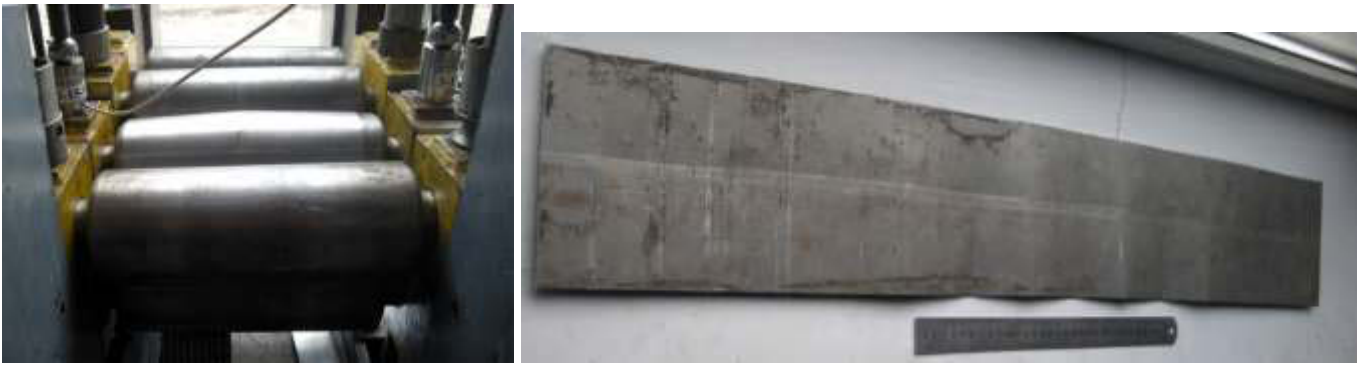
Рисунок 10 – Загальний вигляд роликової системи листопрямуючої машини з 3-м роликком бочкоподібною форми (а) та сталевго зразка з хвилястою крайкою
