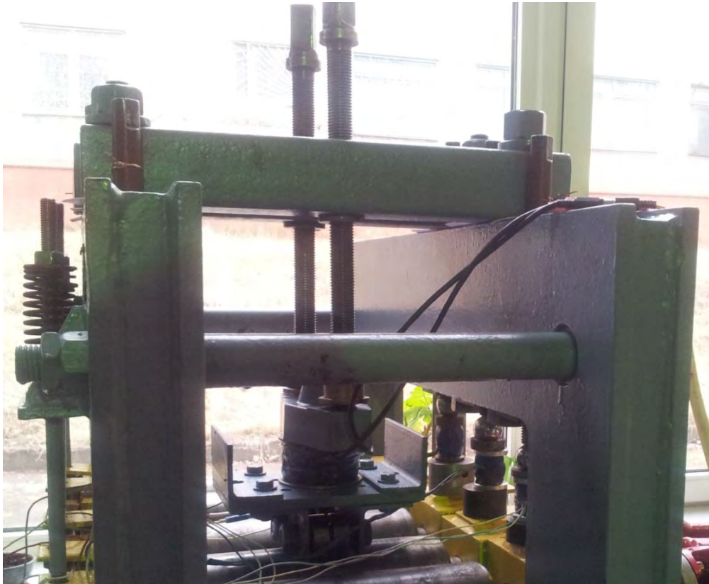
Рисунок 4.1 – Загальний вигляд спеціального пристосування для диференційованого додатку сили до ролика листоправильної машини
