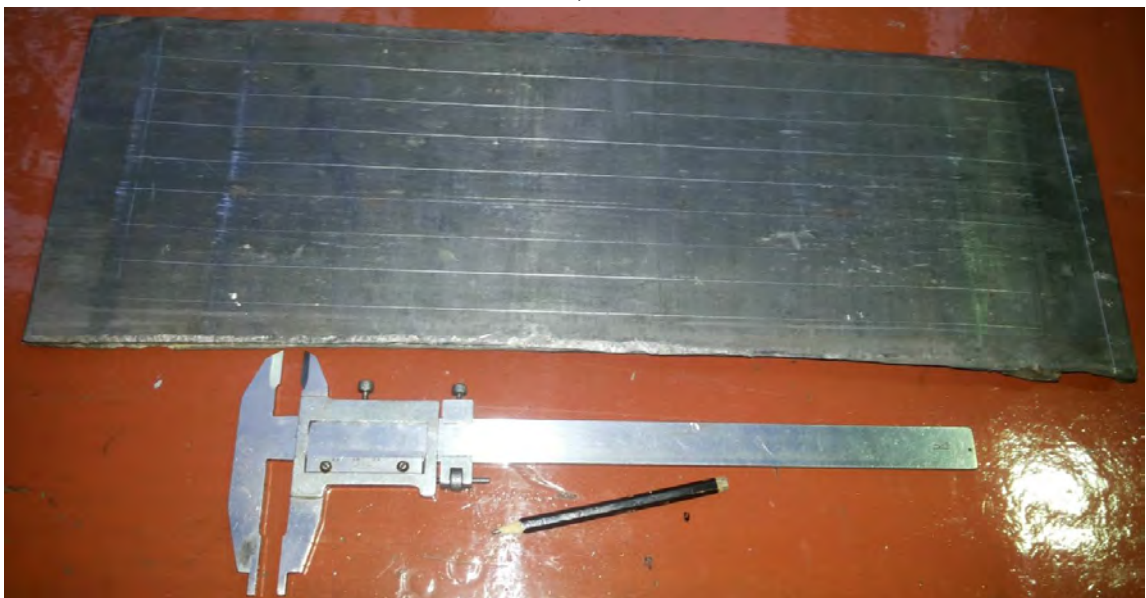
Рисунок 4.9 – Загальний вигляд поверхні листів (а – в проекції, б – зверху) для визначення подовження волокон при експериментальному дослідженні на листоправильній машині з диференційованим додатком сили правки по ширині листа
