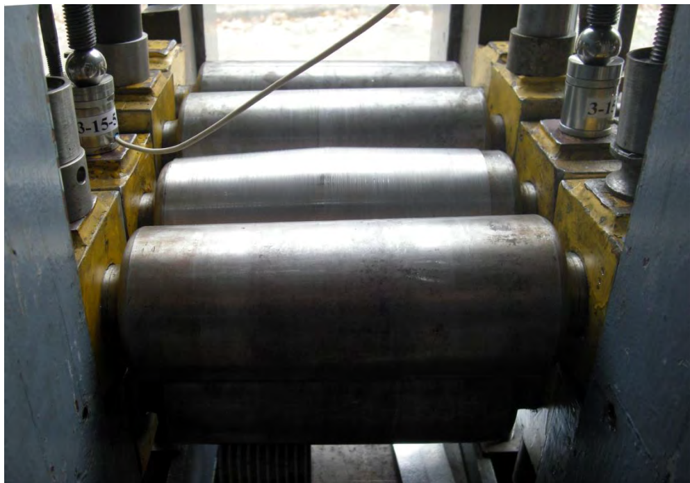
Рисунок 4.11 – Роликова система листоправильної машини з 3-м роликом бочкоподібною формою для імітації вигину по центру листа
