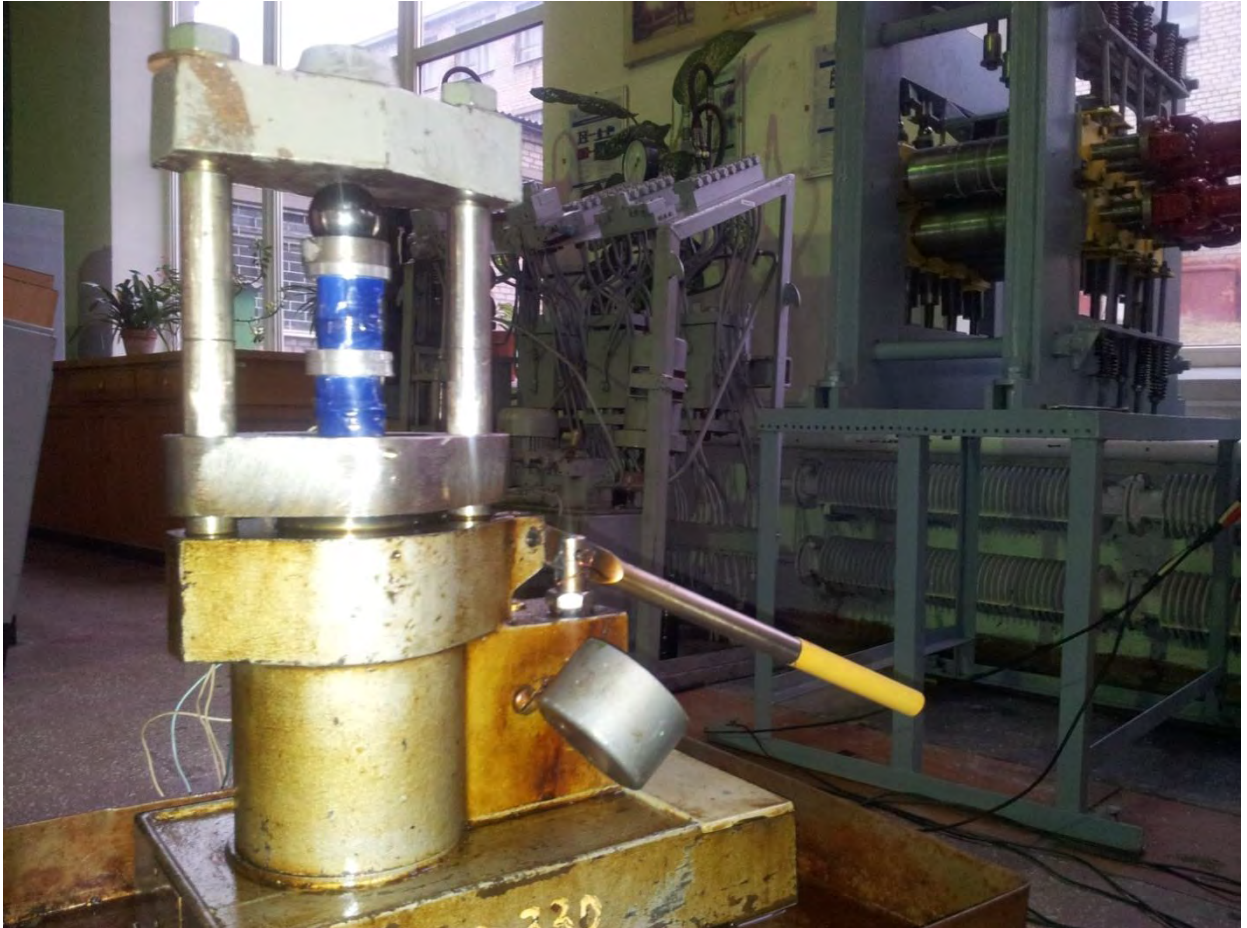
Рисунок 4.5 – Схема тарування кільцевих месдоз на гідравлічному пресі
