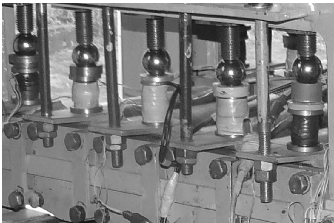
Рисунок 2.12 – Система силовимірювальних месдоз під натискними гвинтами установки
