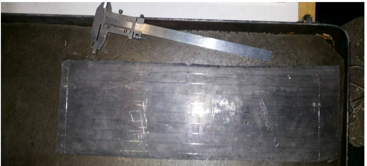
Рисунок 4.8 – Загальний вигляд листів зі свинцю, використовуваних при експериментальному дослідженні на листопривальній машині з диференційованим додатком сили правки по ширині смуги
