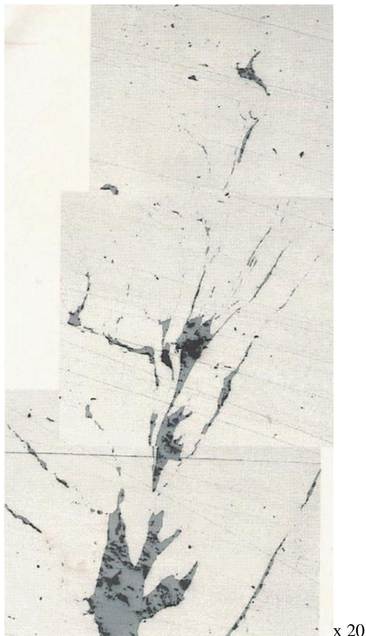
Рисунок 5.9 – Мікроструктура осьових дефектів днища, підсаженого на 30 %
