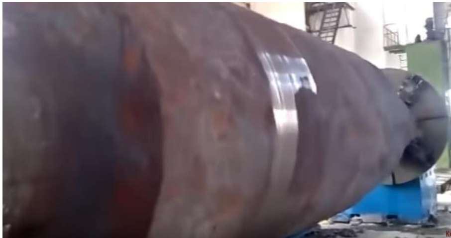
Рисунок 1 – Чорнова обробка деталі на важкому токарному верстаті
