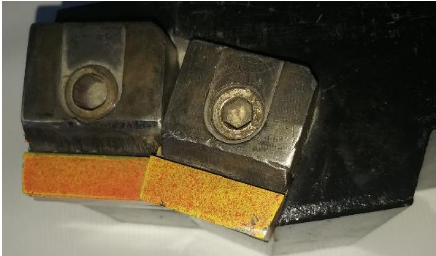
Рисунок 7 – Різальна частина ступінчастого збірного різця
