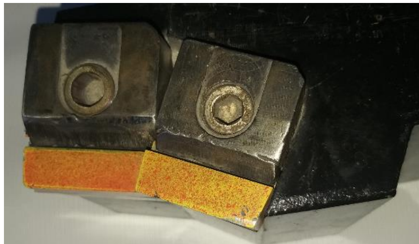
Рисунок 3.16 – Різальна частина ступінчастого збірного різця
