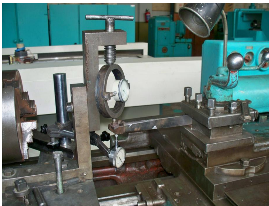
Рисунок 2.22 – Общий вид установки для определения прогибов расточного резца
