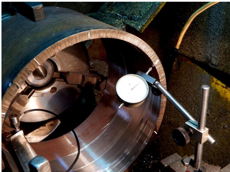
Рисунок 5.18 – Измерение радиального биения обработанного отверстия
