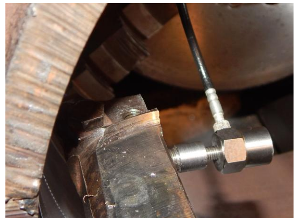
Рисунок 2.28 – Крепление датчика по направлению оси Y
