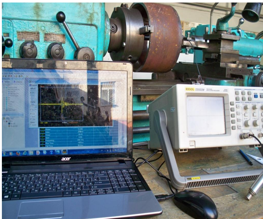
Рисунок 2.24 – Общий вид измерительного комплекса для исследования собственных частот
