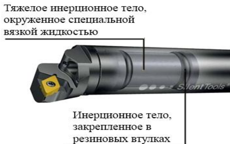
Рисунок 1.16 – Модульный расточной инструмент с антивибрационной оправкой Silent Tools
