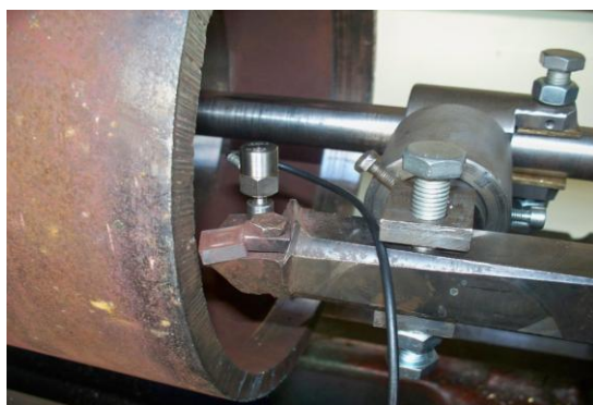
Рисунок 5.3 – Расположение датчика на державке для измерения собственных частот
