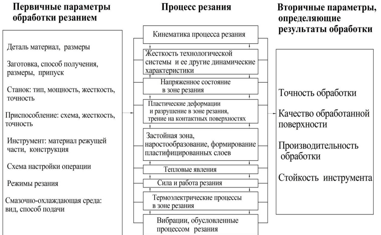
Рисунок 2.1 – Структурная схема механической обработки
