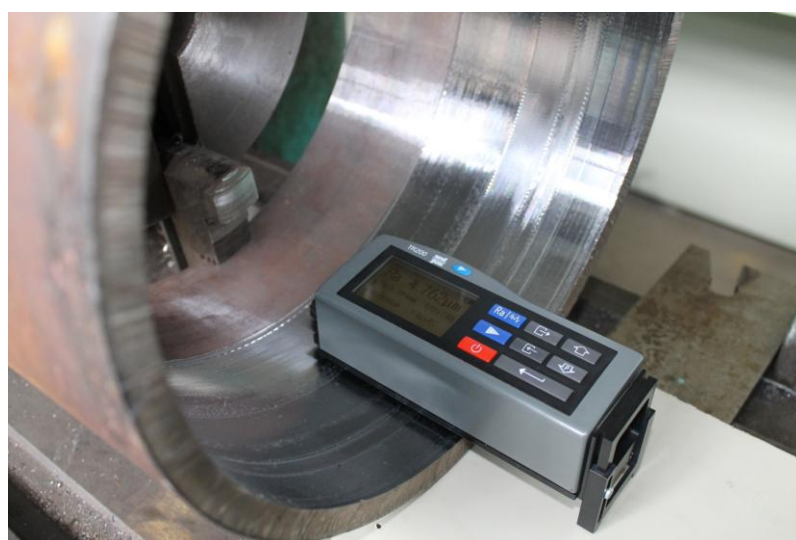
Рисунок 5.13 – Измерение шероховатости поверхности расточенных дорожек
