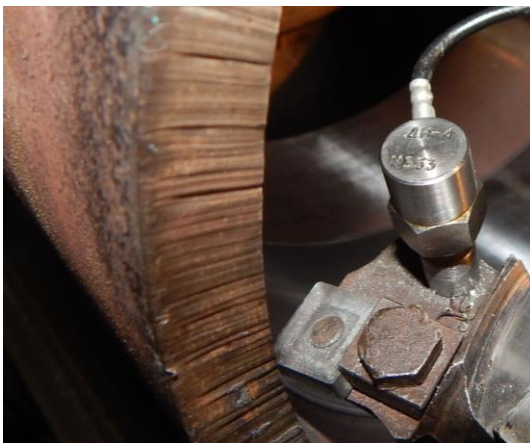
Рисунок 2.27 – Крепление датчика по направлению оси Z
