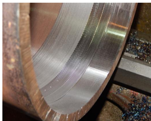
Рисунок 5.7 – Вид расточенных в отверстиях дорожек
