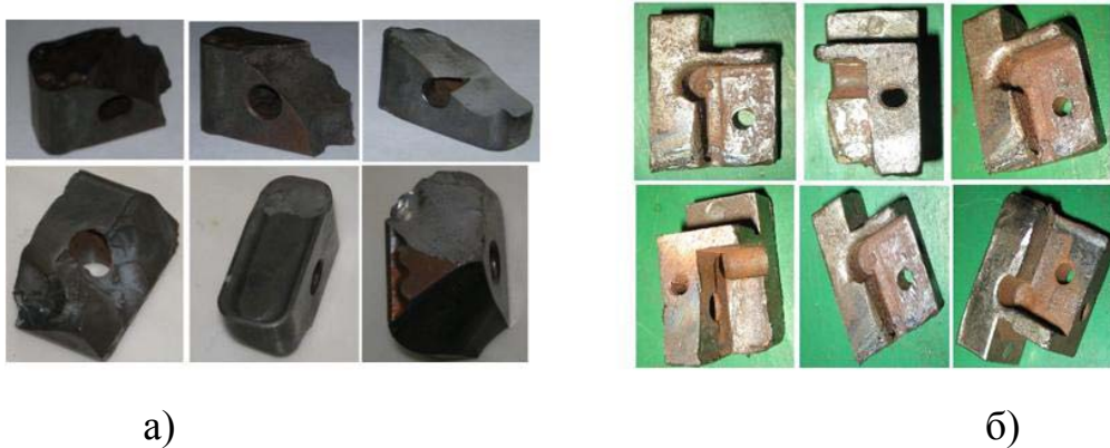
Рисунок 3.5 – Примеры отказов тангенциальных пластин (а) и кассет сборных резцов с тангенциальным расположением пластины (б)
