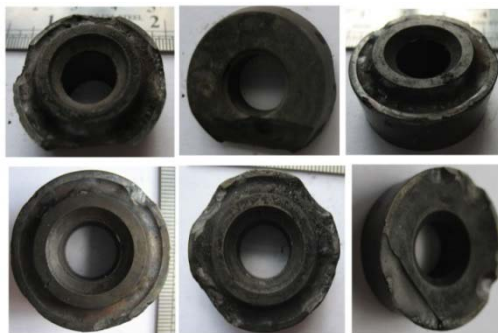
Рисунок 3.3 – Примеры отказов чашечных пластин
