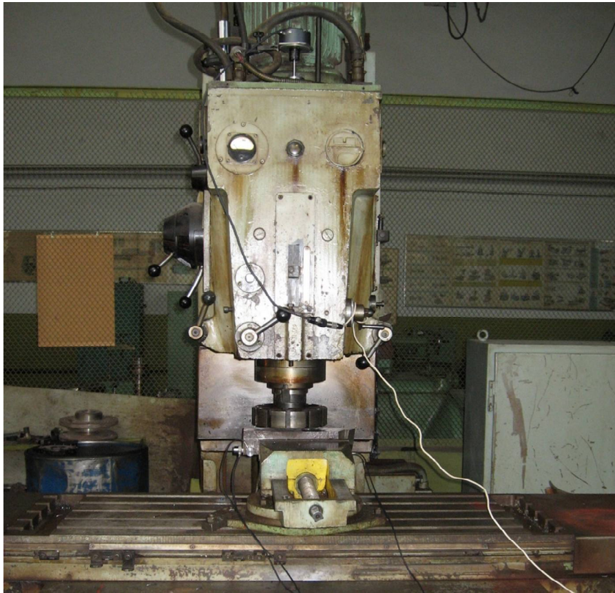
Рисунок 2.2 – Загальний вигляд установки для вимірювання амплітуди вібрацій на фрезерному верстаті ЛГ 26 з допомогою п'єзоелектричних акселерометрів ДН 3, ДН 4 та ДН 5
