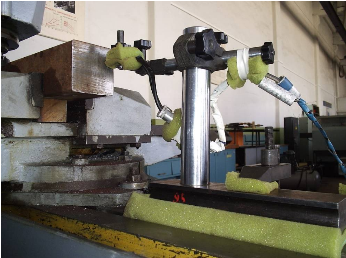
Рисунок 2.7 – Схема закріплення світловолоконного датчика мікропереміщень
