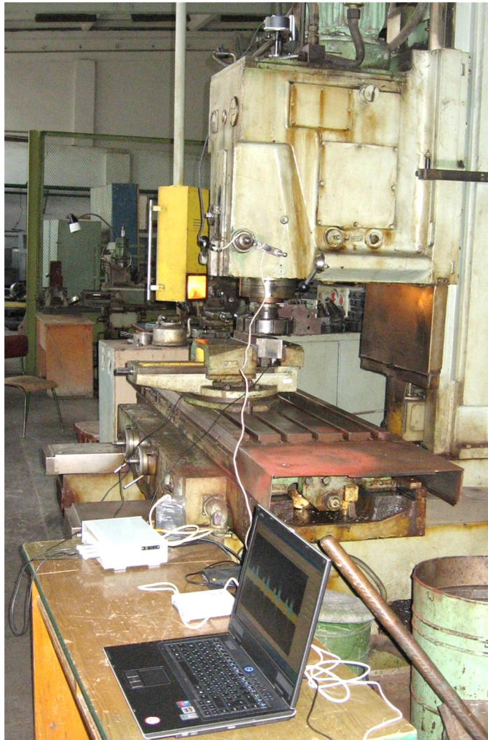
Рисунок 2.5 – Загальний вигляд вимірювального стану на фрезерному верстаті ЛГ 26
