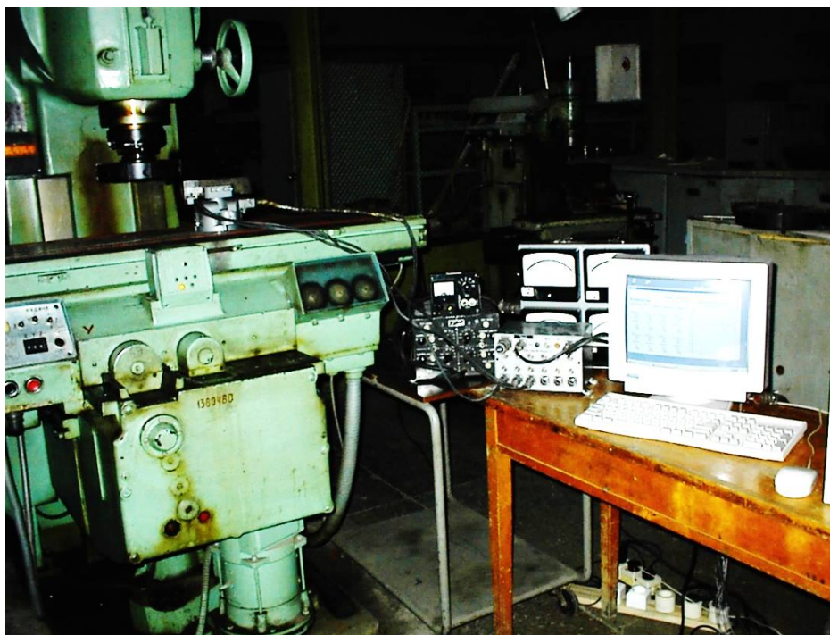
Рисунок 2.1 – Загальний вигляд установки для тестування датчиків вібропереміщення в складі вимірювального комплексу ВІБ-6ЕН та вимірювання сил фрезерування з допомогою тензовимірювальної станції
