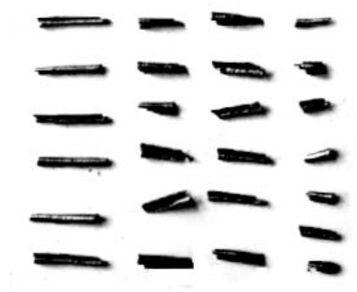
Рис. 16 – Стружка, що зрізується фрезою з роздільною схемою формоутворення, при оброблюванні зубчастих вінців m = 20 мм; z = 316 . Режими різання - \Delta = 0,65 мм
