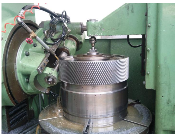
Рисунок 1.2 – Оброблення шевронного колеса черв'ячною фрезою
