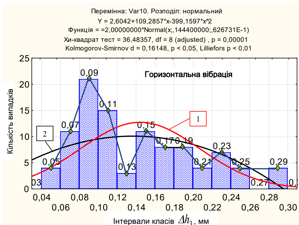
Рисунок 4.16 – Гістограма та полігон щільності розподілу відхилення товщини шару наплавленого металу на робочу поверхню деталі \Delta h_3 : 1 – крива нормального закону розподілу; 2 – функція полінома другої степені
