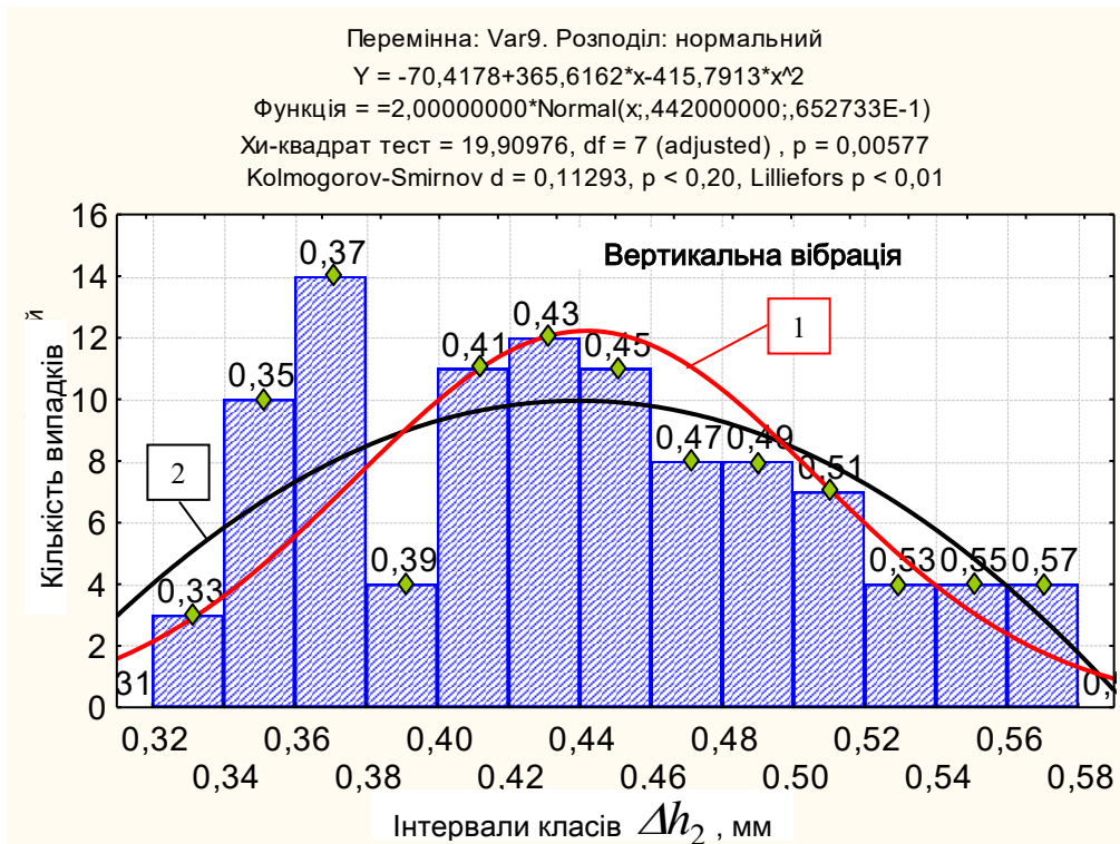
Рисунок 4.15 – Гістограма та полігон щільності розподілу відхилення товщини шару наплавленого металу на робочу поверхню деталі \Delta h_2 : 1 – крива нормального закону розподілу; 2 – функція полінома другої степені
