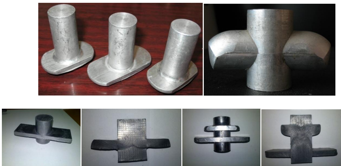
Рис. 1. Детали, полученные способом бокового выдавливания.
