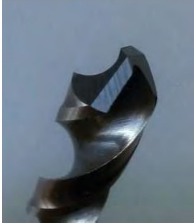
Рисунок2 - Спіральне свердло для обробки вуглепластику
