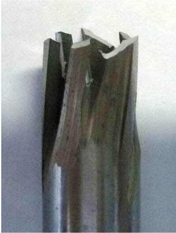
Рисунок 1 - Кільцеве свердло для обробки вуглепластику
