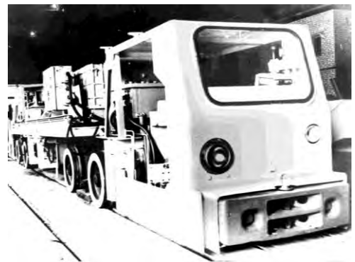
Рисунок 2 - Шарнірно-зчленований шахтний локомотив E10
