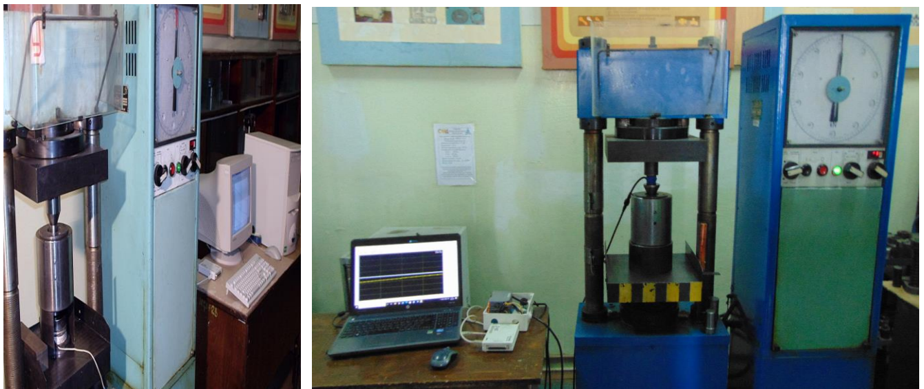
Рисунок 2.4 – Випробувальні машини МС-500 (а) та МС-2000 (б)
