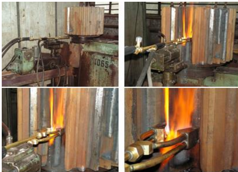
Рис. 1 Машинне загартування зубів шестерні m = 25
