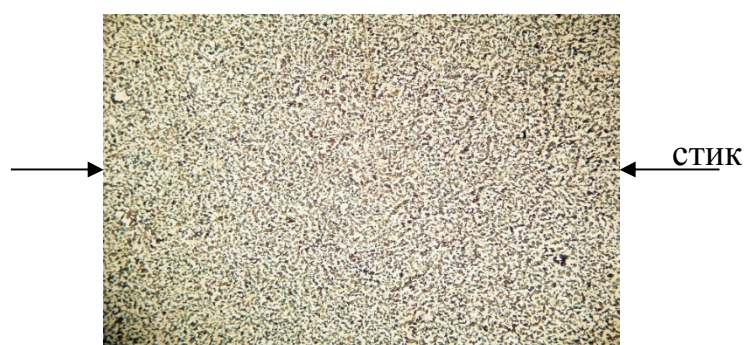
Рисунок 15 – Мікроструктура зварного з'єднання сталі 45 отриманого дифузійним зварюванням у вакуумі при попередньому загартуванні зразків у воду і застосуванні вуглеводневої суміші ( x50 ) (оптична мікроскопія)
