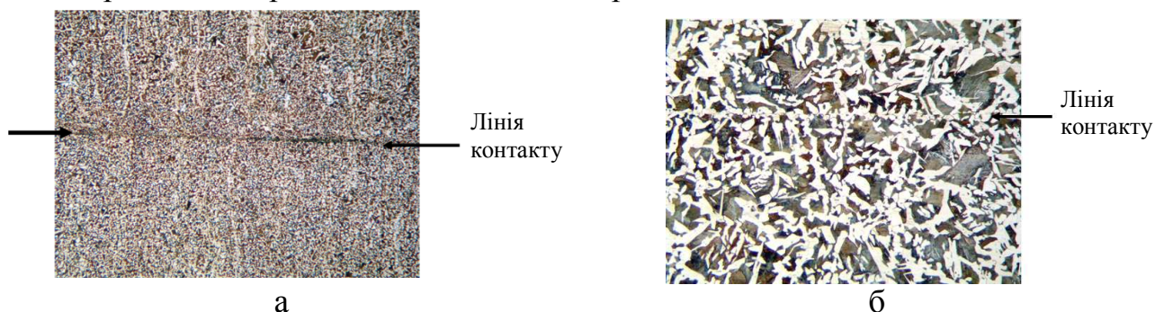
Рисунок 14 – Мікроструктура зони з'єднання зразка сталі 45 з попередньою обробкою поверхні тонким шліфуванням, x100 (а) та поліруванням, x 125 (б) (оптична мікроскопія)
