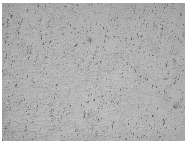
Рисунок 5.8 – Мікроструктура сплаву АД31 у вихідному стані (оптична мікроскопія після хімічного травлення, \times 250 )
