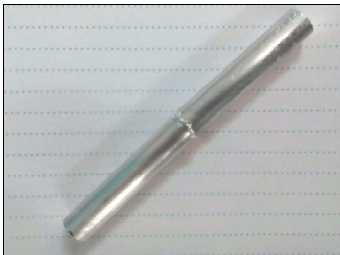
Рисунок 5.14 – Зовнішній вигляд зварного зразка з АДЗ1, одержаного на оптимальному режимі через 6 шарів алюмінієвої фольги
