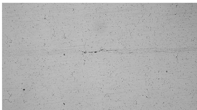
Рисунок 5.12 – Мікроструктура з'єднання сплаву АДЗ1, отриманого на оптимальному режимі через 4 шари алюмінієвої фольги (оптична мікроскопія після хімічного травлення, \times 250 )
