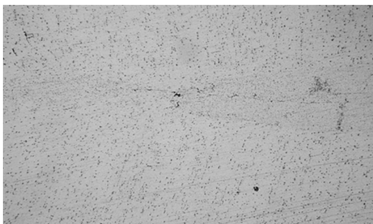
Рисунок 5.11 – Мікроструктура з'єднання сплаву АДЗ1, отриманого на оптимальному режимі через 2 шари алюмінієвої фольги (оптична мікроскопія після хімічного травлення, \times 250 )
