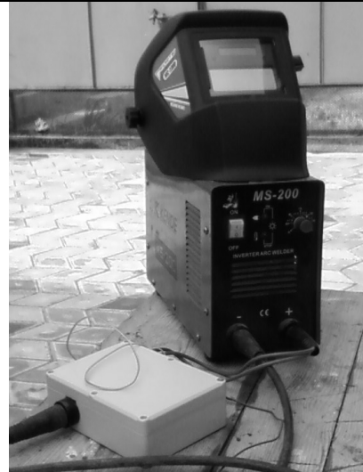
Рис. 42. Універсальний стабілізатор дуги підключений до інверторного зварювального джерела
