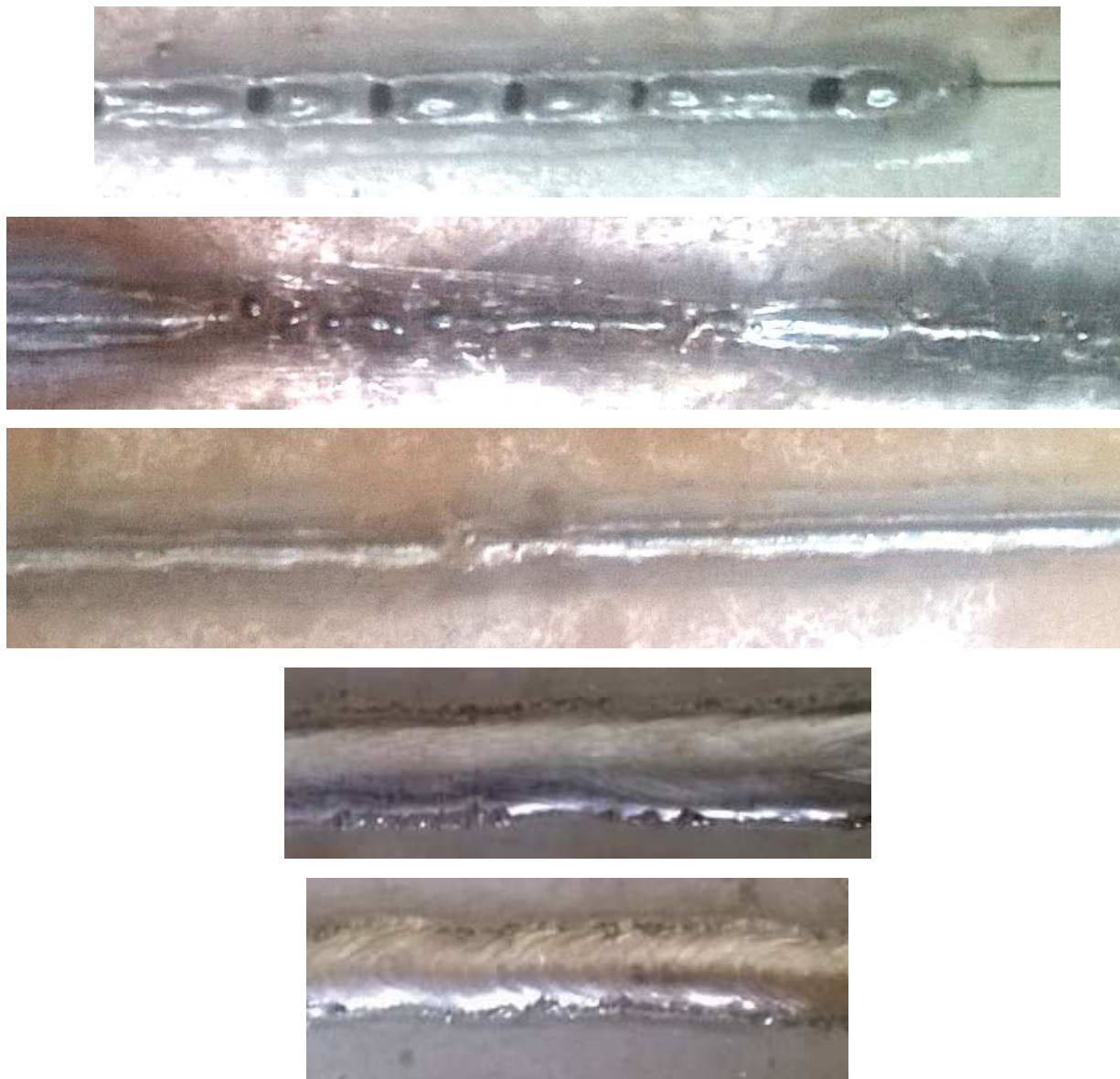
Рис. 7.1. Дефекти зварних швів з-за зниженої якості електроенергії
