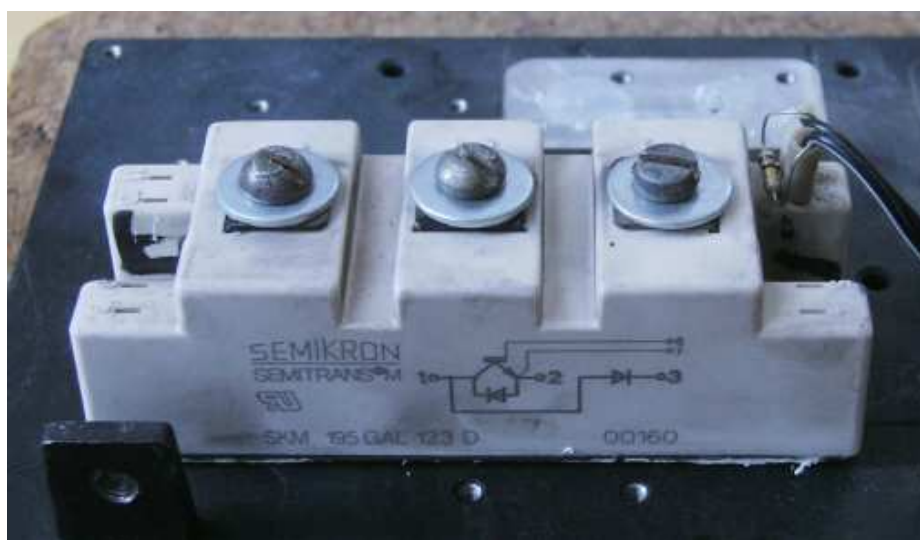
Рис. 2.27. Силовий IGBT модуль 150 А 1200 В на тепловідводі
