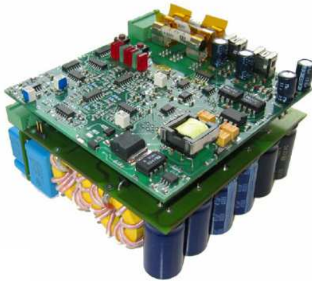
Рис. 1.29. Експериментальний зразок випрямляча з «електронним дроселем», виготовлений в Power Electronic Systems Laboratory, Swiss Federal Institute of Technology (ETH), Zurich
