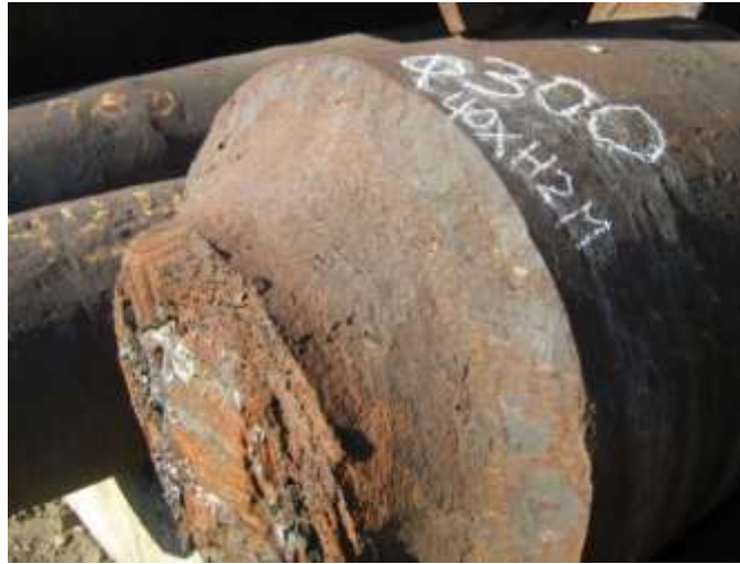
Рисунок 5.14 – Зразок різку поковки діаметром 300 мм 40ХН2МА. Різання проводилося плазмотроном ПР–6 на зворотній полярності. I = 600 \text{ А} ;
