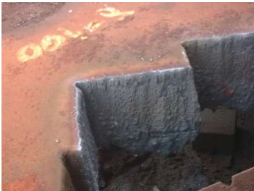
Рисунок 5.5 – Зразок різку листового прокату 12X18H10Т товщиною 100 мм: різання проводилось плазмотроном ПР–5 I=650 А; d_c=3 мм
