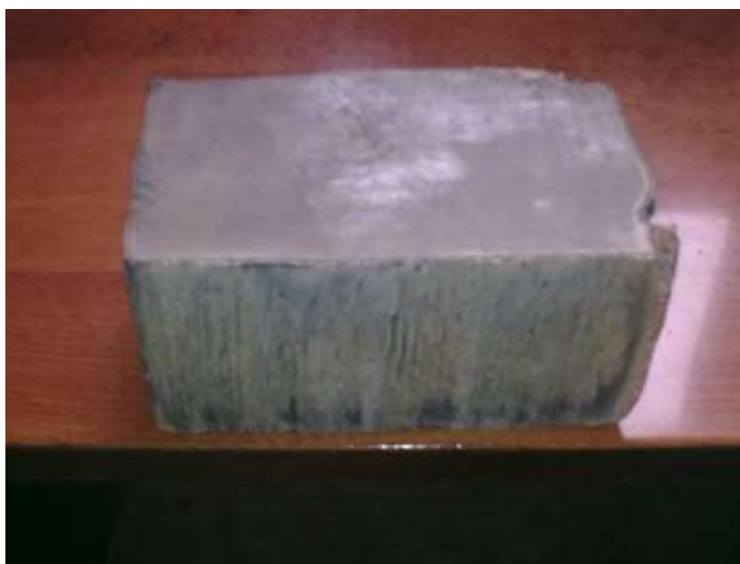
Рисунок 5.6 – Зразок різку листового прокату титана ВТ 1–0 товщиною 100 мм: різання проводилось плазмотроном ПР–4 I=500 А; d_c=2 мм
