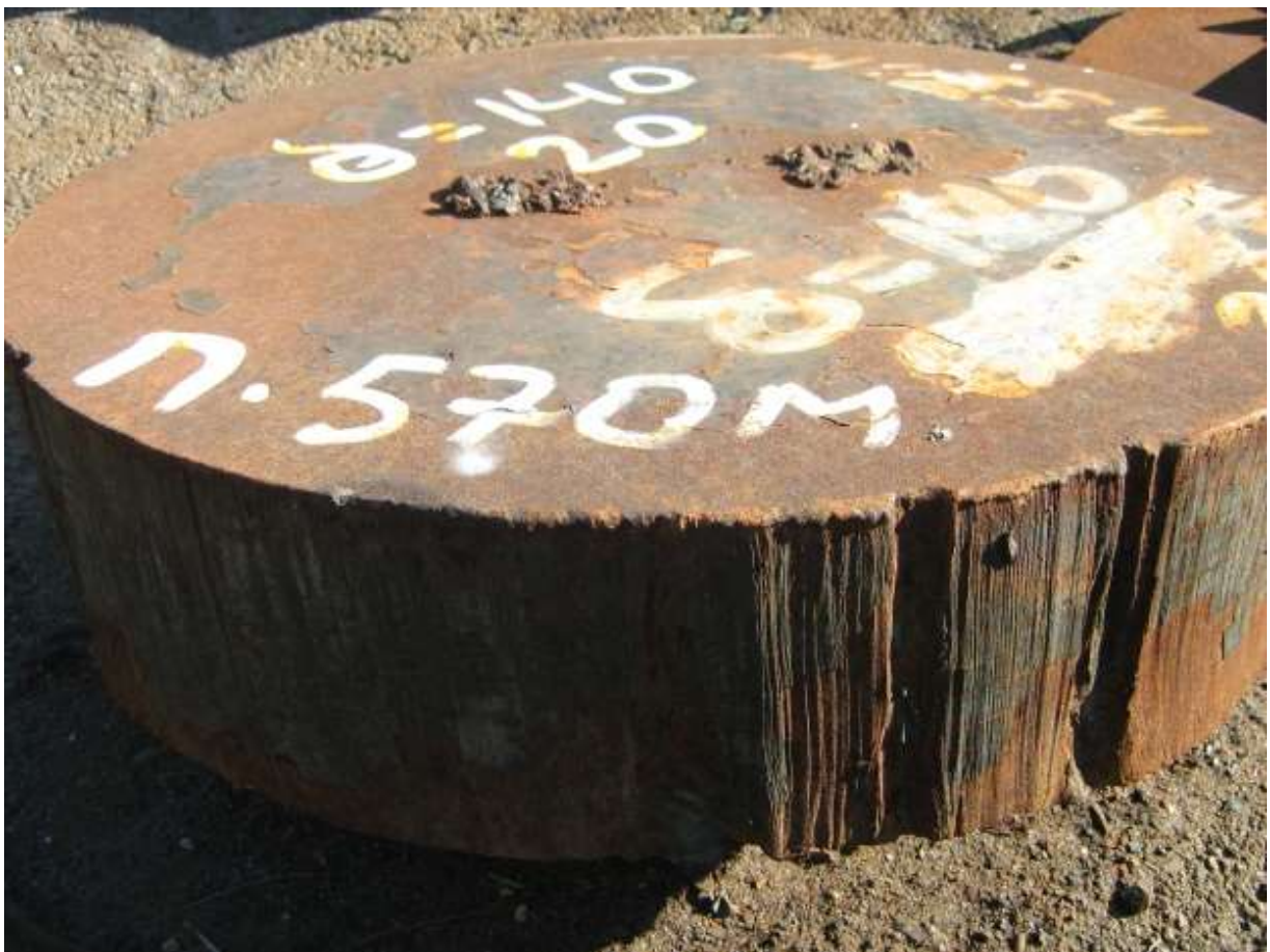
Рисунок 5.4 – Зразок різку листового прокату ст. 20 товщиною 140 мм: різання проводилось плазмотроном ПР–6 на зворотній полярності I=600 А; d_c=3,5 мм
