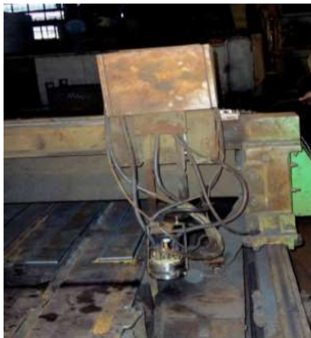
Рисунок 5.3 – Плазмотрон ПР-6, встановлений на машині ППлКЦ-2,5
