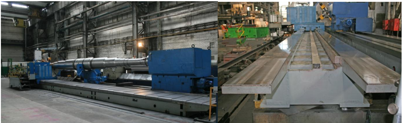
Рис. 15. Важкий токарний верстат мод. 1К675Ф3 вантажопідйомністю 100 т, діаметром оброблення над станиною 2550 мм, довжиною 12500 мм
