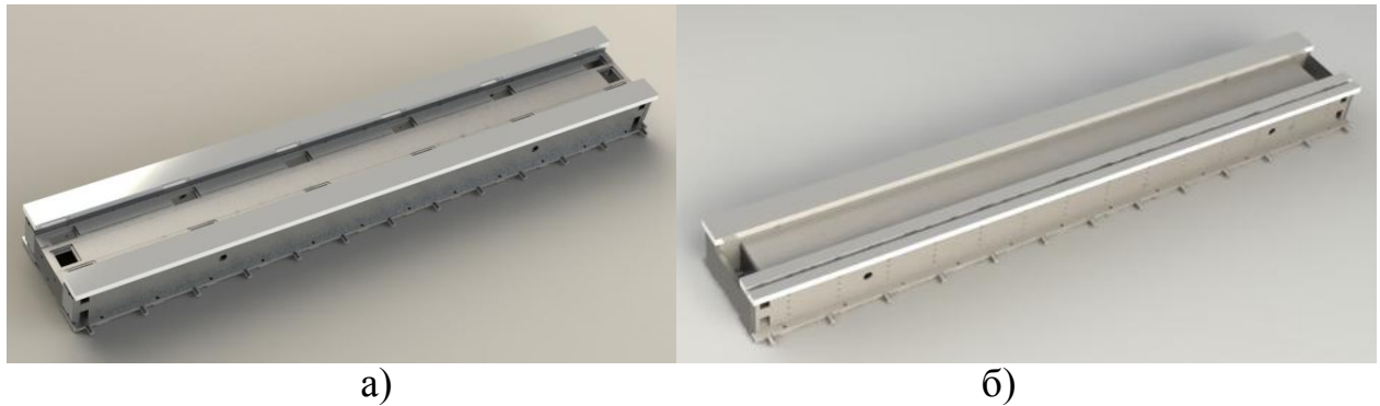
Рис. 8. 3D-моделі секції станин (а) під супорт; (б) під виріб
