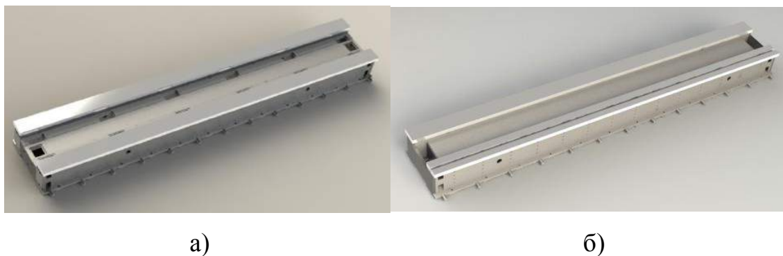
Рисунок 4.20 – 3D-моделі секції станин (а) під супорт; (б) під виріб
