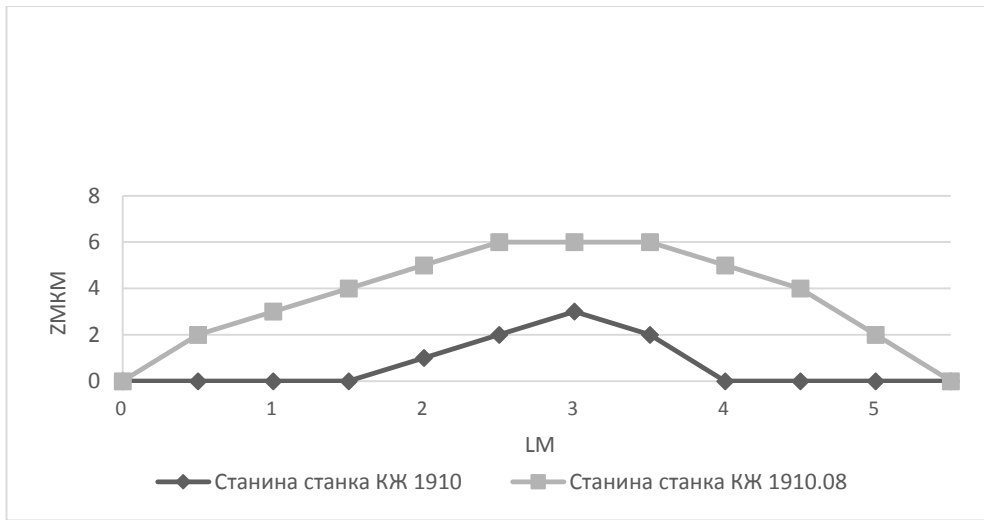
Рисунок 4.35 – Прогинання станини під власною вагою при вижиманні її за індикатором на 0,01 мм двома башмаками.
