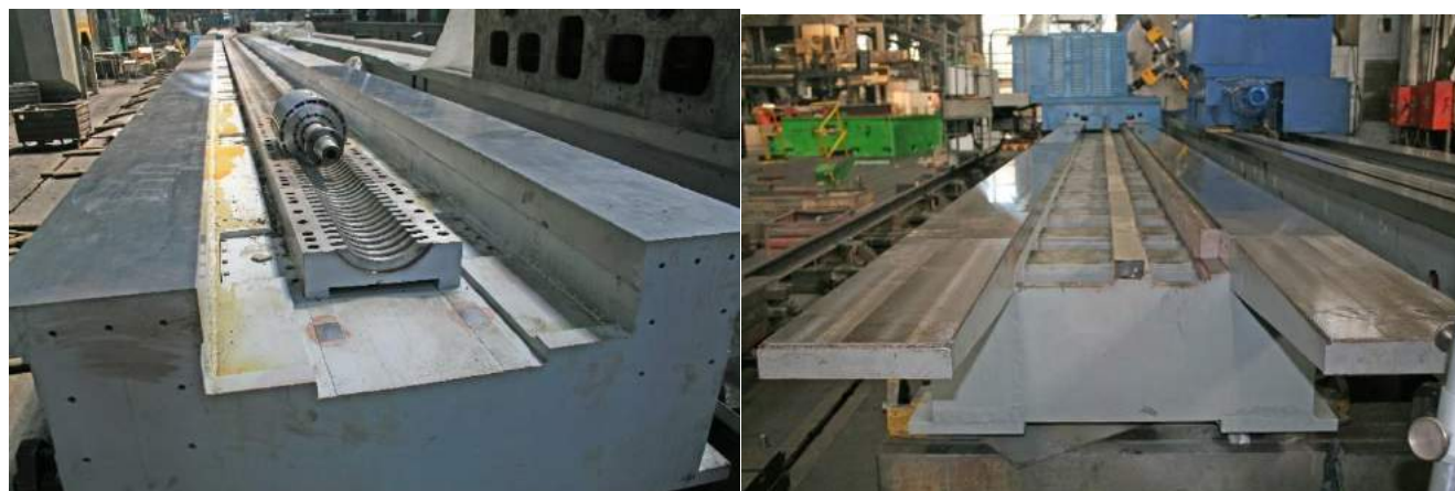
Рисунок 5.1 – Варіанти виготовлення станин важких верстатів
