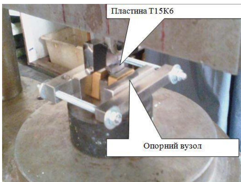
Рис. 3.7 – Тестування на згинання змінної різальної пластини з Т15К6 на устаткуванні ZD-40
