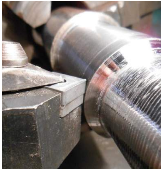
Рисунок 2.8 – Положення пластини відносно вала при визначенні опору руйнуванню і зношуванню при контактному навантаженні на токарних верстатах
