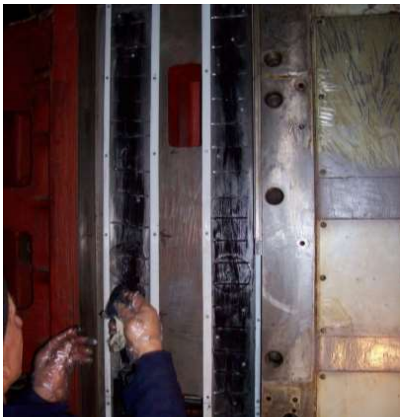
Рисунок 5.13 - Процес втирання першого адгезійного шару матеріалу «моглайс FL/P» у поверхню напрямних.
