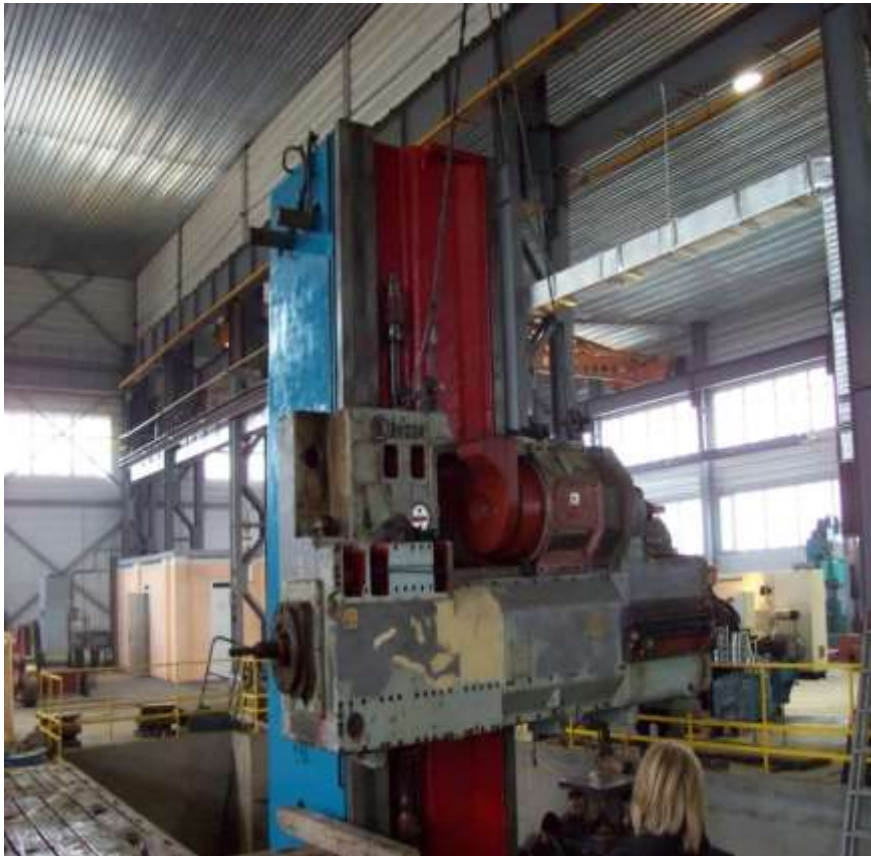
Рисунок 5.14 – Розточувальна бабка встановлена на станину та притягнута до неї притискними планками.
