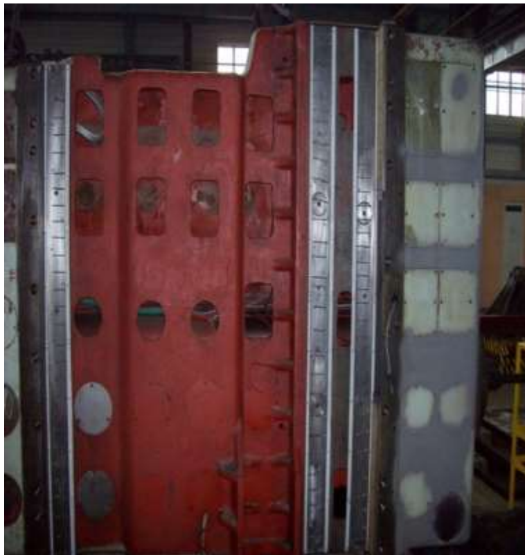
Рисунок 5.12 – Три зачищені напрямні на бабці, по краях яких закріплені обмежувачі товщини шару матеріалу (тефлонові смуги товщиною 2 мм).
