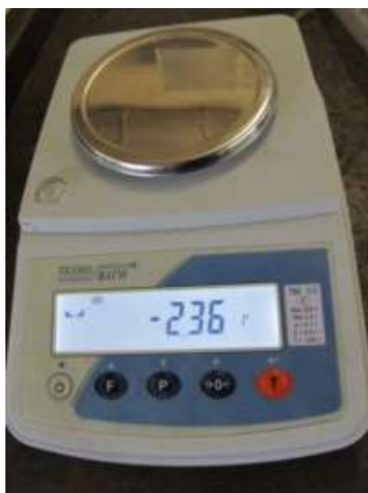
Рисунок 2.24 – Ваги лабораторні електронні загального призначення ТВЕ-0,5-0,01.
