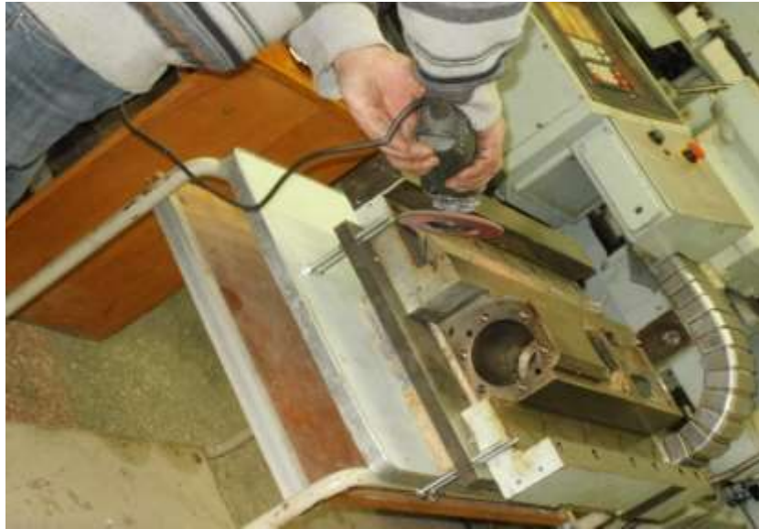
Рисунок 3.3 – Зачищення поверхні напрямних каретки шліфувальним кругом.
