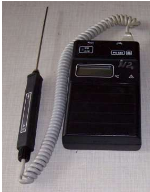
Рисунок 5.1 - Термометр цифровий портативний PU525
