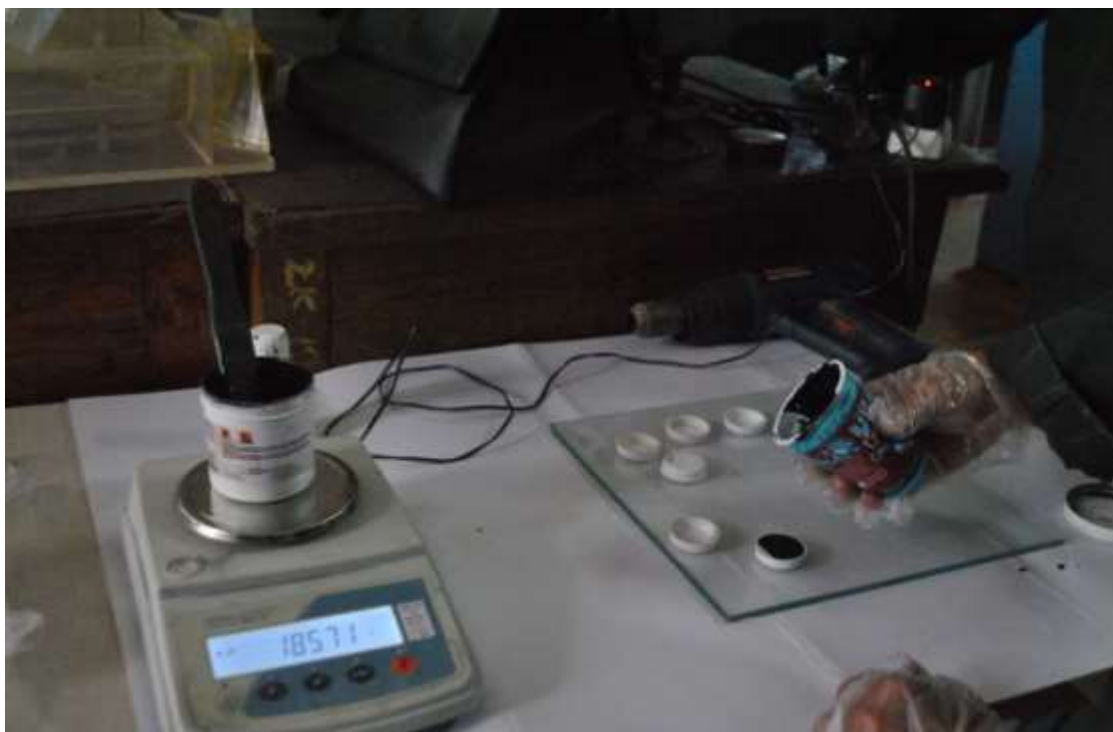
Рисунок 5.2 - Заповнення першого зразка матеріалом методом ручного перемішування двох компонентів матеріалу moglice FL/P
