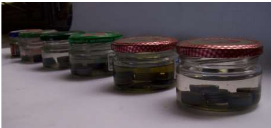
Рисунок 2.23 - Зразки полімеру в ємності з різною рідиною.
