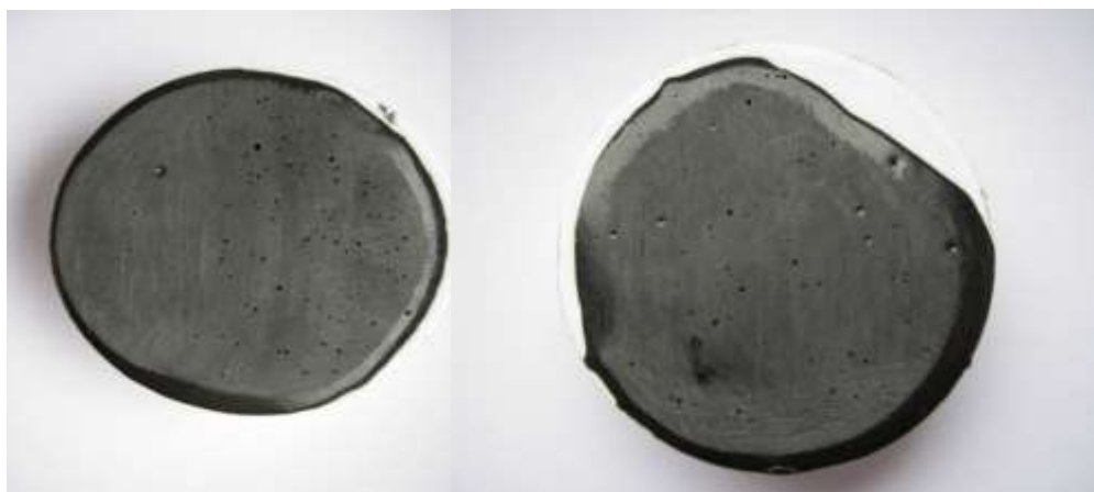
Рисунок 5.7 - Зразки, отримані в результаті ручного (а) і механічного (б) перемішування матеріалу при переливанні тонким струменем.
