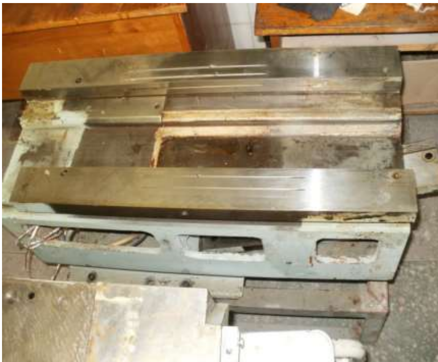
Рисунок 3.1 – Загальний вигляд хрестового супорта токарного автоматного комплексу ПАБ 130
