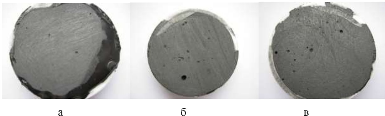
Рисунок 5.9 – Зразки, отримані в результаті ручного змішування пастоподібного матеріалу (а), розтирання матеріалу по пластині (б), нагрівання зразка феном (в).
