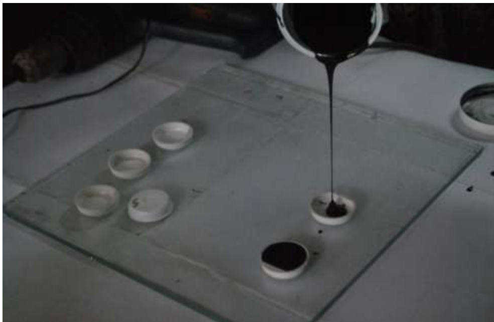
Рисунок 5.3 - Заповнення другого зразка матеріалом шляхом змішування його компонентів вручну і переливання матеріалу тонким струменем
