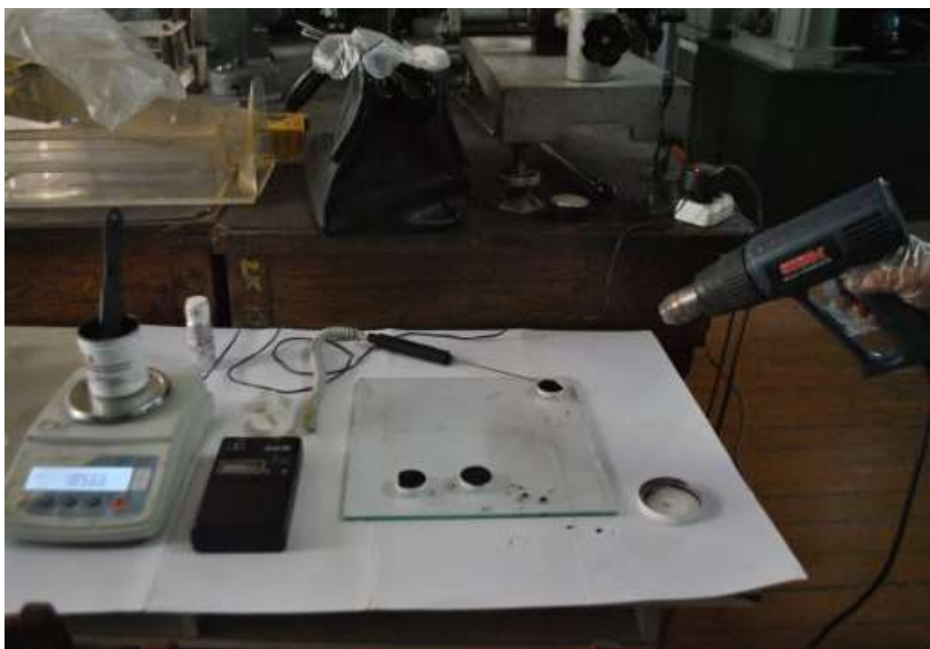
Рисунок 5.4 - Нагрівання третього зразка феном
