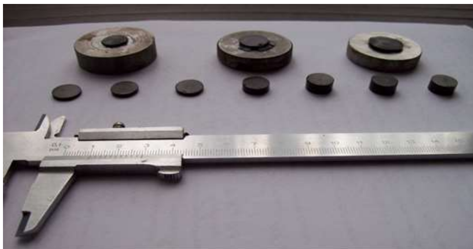
Рисунок 2.21 – Зразки з полімерного матеріалу «моглайс».
