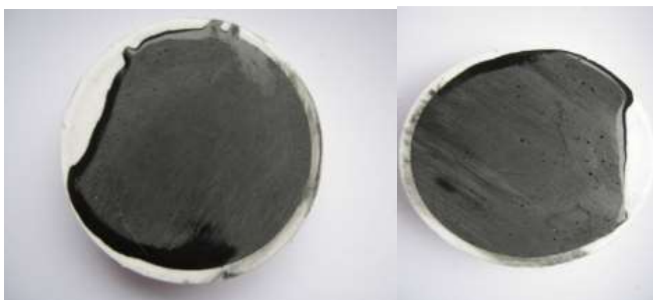
Рисунок 5.8 – Зразки, отримані в результаті ручного (а) і механічного (б) перемішування матеріалу при нагріванні феном.
