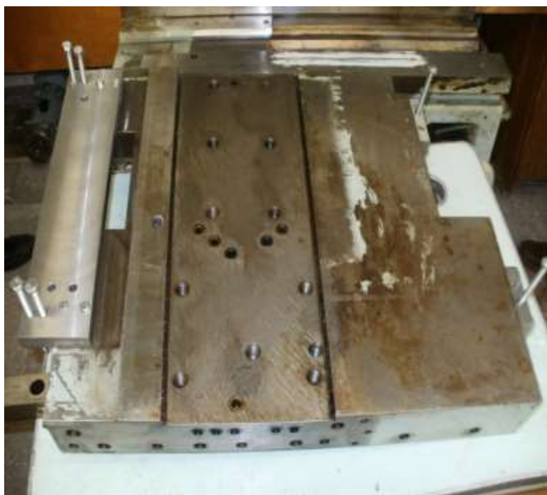
Рисунок 3.2 – Встановлення юстирувальних та монтажних гвинтів.
