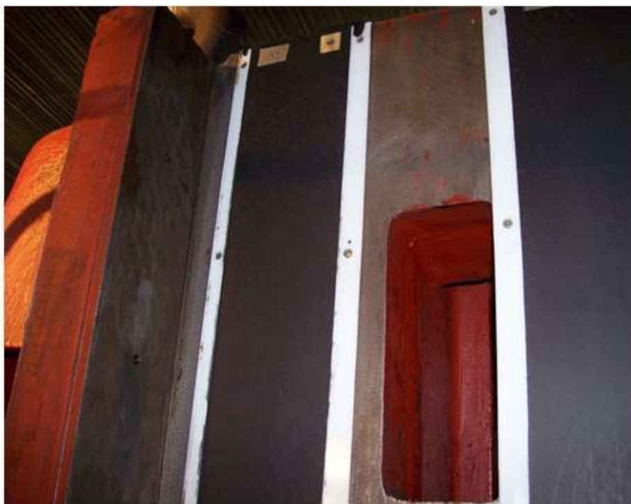
Рисунок 5.16 – Поверхня виготовлених напрямних на розточувальній бабці після полімеризації матеріалу.
