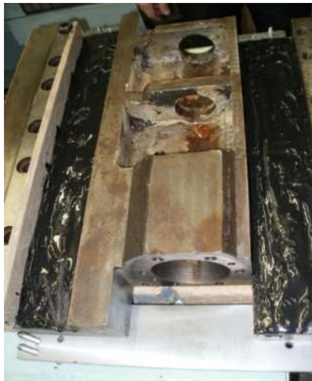
Рисунок 3.4 – «моглайс» нанесено на напрямні каретки.
