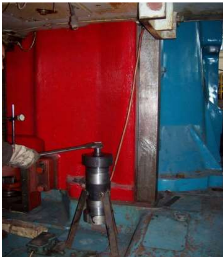
Рисунок 5.15 - Нагнітання матеріалу «моглайс FL/P» у зазор між напрямними на станині та металевою поверхнею на розточувальній бабці.
