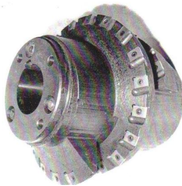
Рисунок 25 – Корпус спеціальної твердосплавної фрези m = 20 мм, оснащеної твердосплавними непереточувани поворотними пластинками зі сплаву ВК 10-ХОМ
