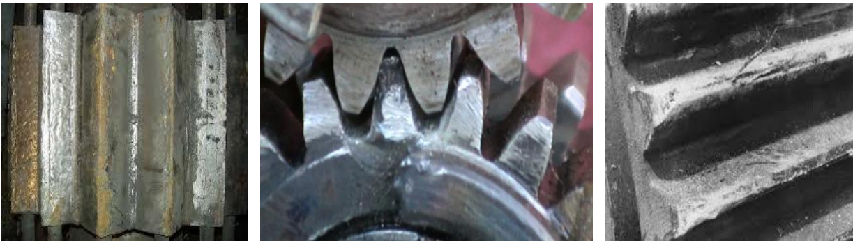
Рисунок 10 – Зношена евольвентна поверхня зубчастого колеса
