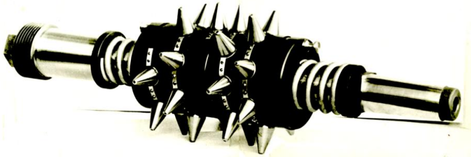
Рисунок 27 – Черв'ячний накатник, m = 20 мм, з конічними накатними роликками
