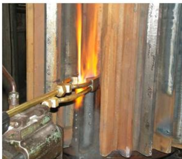
Рисунок 6.27 – Верстат для поверхневої газокисневого гарту зубів шестерні m = 25
