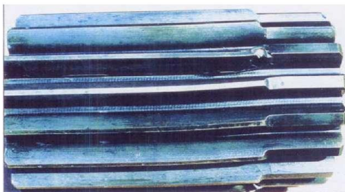
Рисунок А.20 – Пластична деформація зуба біля основи
