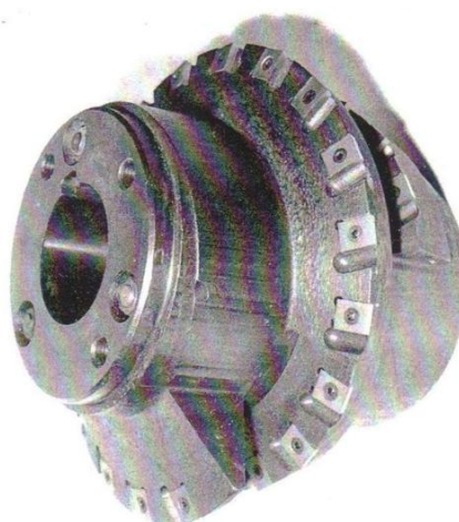
Рисунок 6.11 - Правий корпус спеціальної твердосплавної фрези m = 20 мм, оснащеної твердосплавними неперетачуємою поворотними пластинками зі сплаву ВК 10-ХОМ
