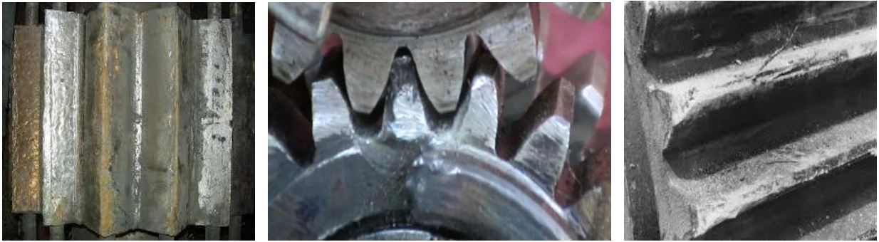
Рисунок 2.5 – Зношена евольвентна поверхня зубчатого колеса
