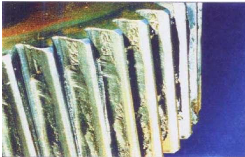
Рисунок А.18 – Пластична деформація при холодній плинності матеріалу (при температурі нижче температури рекристалізації)
