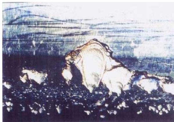
Рисунок А.25 – Фрагменти бічної поверхні зубів, пошкодженої луценням раковини розташовуються такими ж періодичними рядами.
