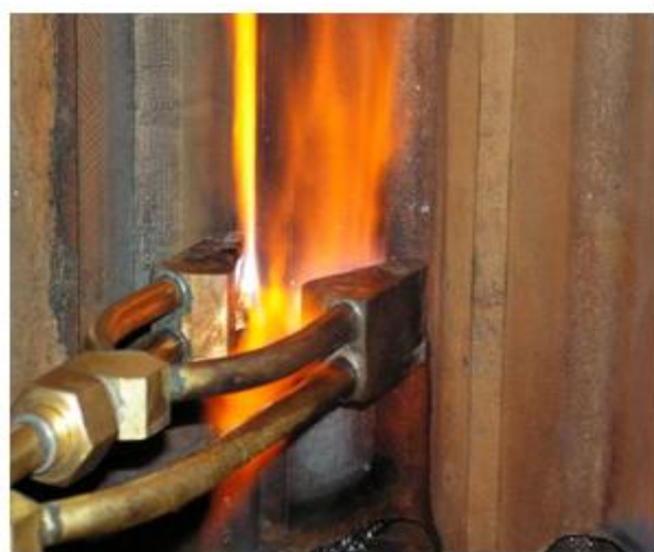
Рисунок 6.27 – Верстат для поверхневої газокисневого гарту зубів шестерні m = 25
