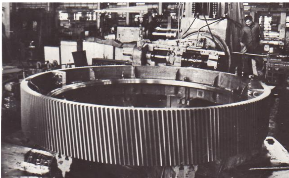
Рисунок 6.21 - Обробка ППД зубчастого вінця m = 20 мм; z = 244 ; \beta = 5^{\circ}38'02'' ; b = 500 мм
