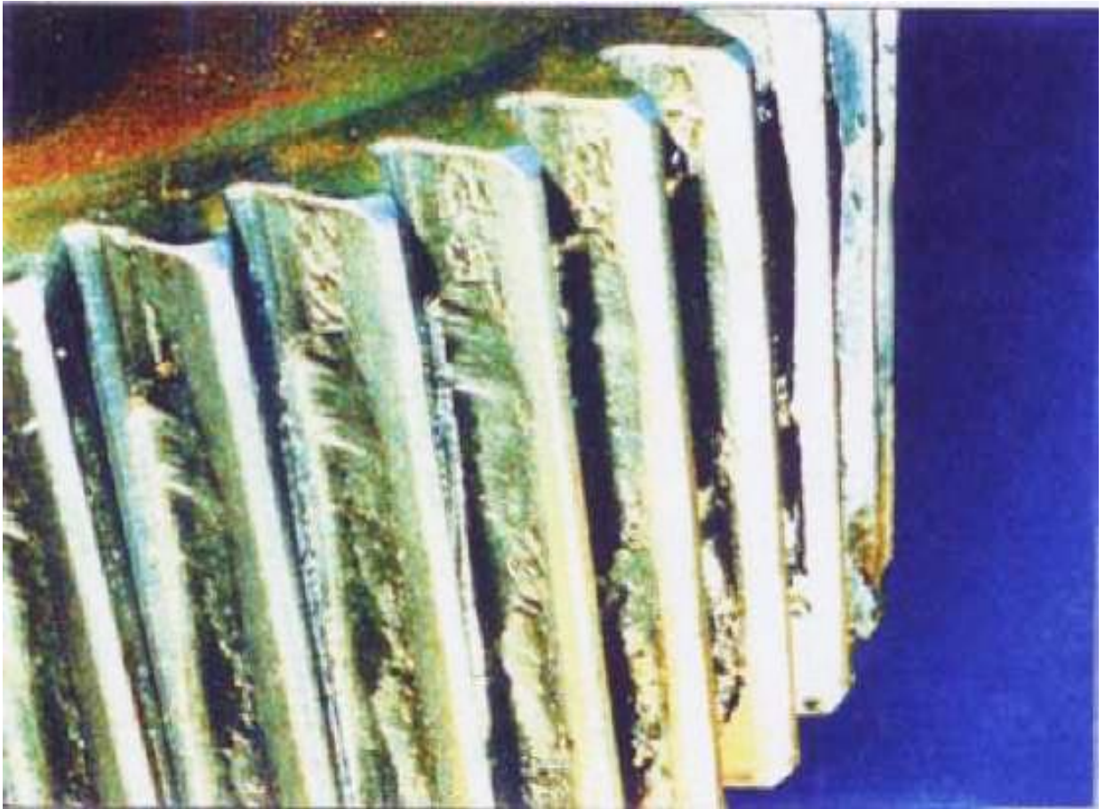
Рисунок 3.11 – Пластична деформація при холодній текучості матеріалу (при температурі нижче температури рекристалізації)
