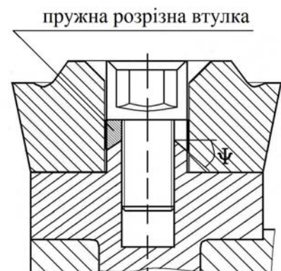
Рисунок 7 – Удосконалена конструкція збірного чашкового різця (патент №74617)
