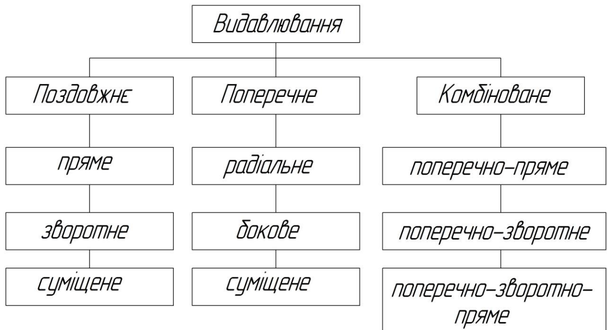
Рисунок 1.2 – Класифікація способів видавлювання
