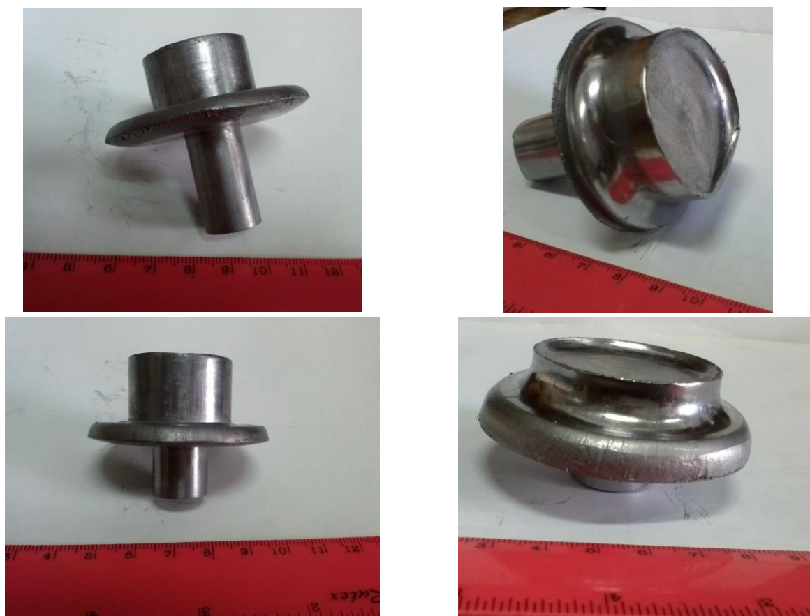
Рисунок 5.15 – Відхилення форми фланця, дефекту «сідло»
