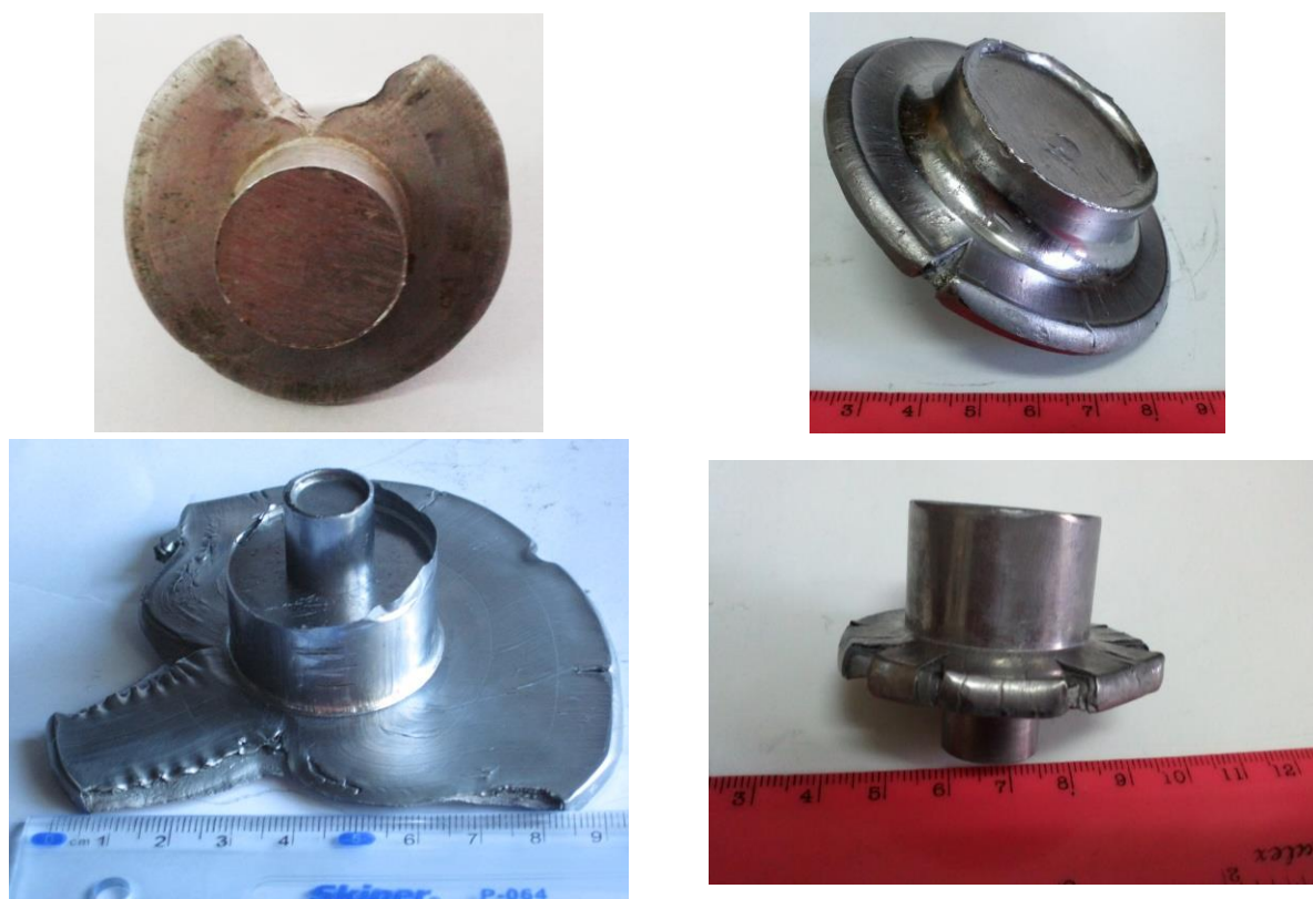
Рисунок 5.16 – Розриви і тріщини при комбінованому видавлюванні
