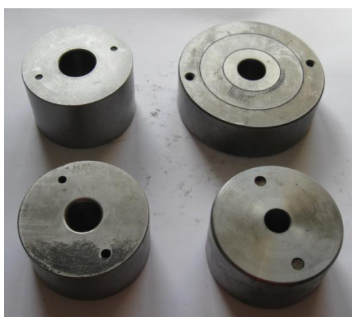
Рисунок 2.8 – Комплект матриць і пуансонів для проведення експериментів
