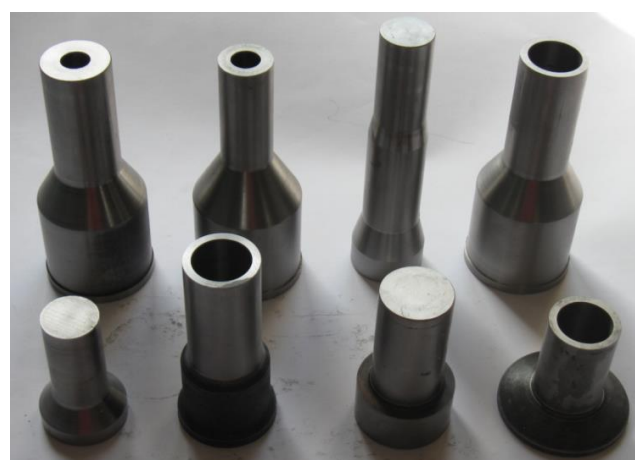
Рисунок 2.8 – Комплект матриць і пуансонів для проведення експериментів
