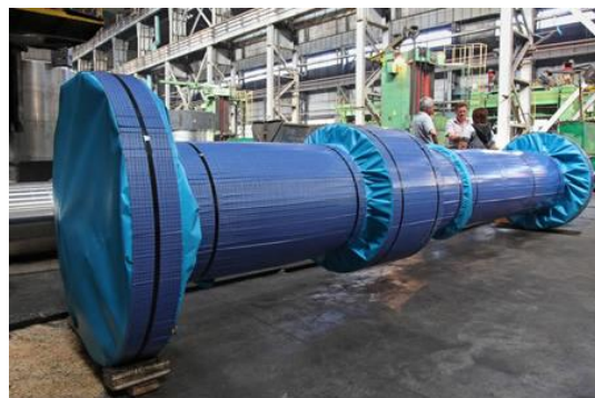
Рисунок 3.2 - «Гідровал» Вага: 17800 кг
