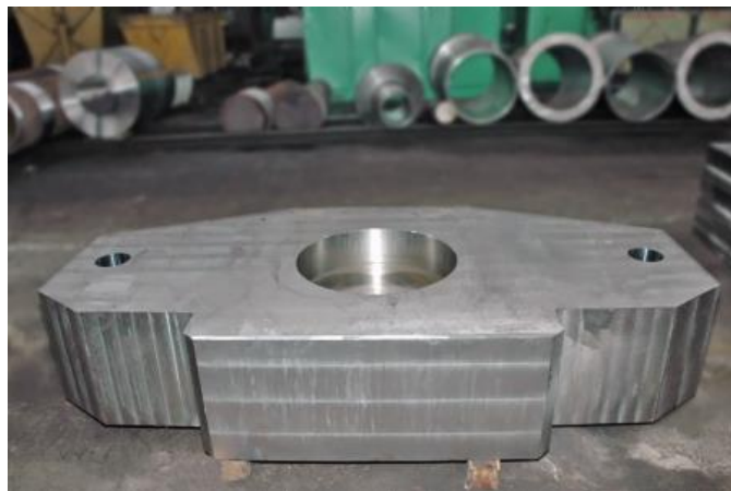
Рисунок 3.18 - «Рухома траверса» Вага: 11960кг
