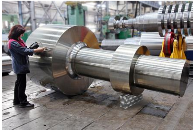
Рисунок 3.5 - «Хвостовик» Вага: 12200кг
