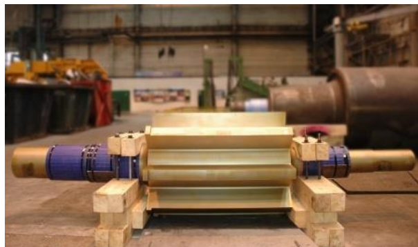
Рисунок 3.8 - «Вал ротора» Вага: 5800 кг
