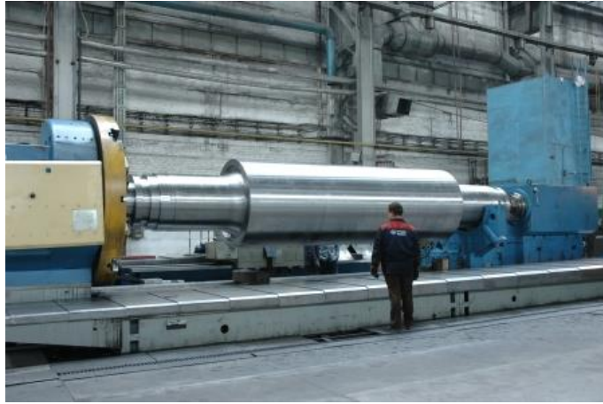
Рисунок 3.11 - «Валок опорний» Вага: 68000кг
