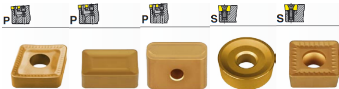
Рис. 5.6. Пластини різальні (Pramet), що рекомендовані для обточування деталей на важких верстатах (рекомендовані подачі – 0,45–1,7 мм/об., глибина різання – 4–27 мм, швидкість різання – 135–250 м/хв.)
