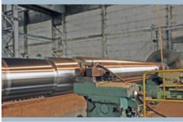
Рисунок 3.15 - «Гребний вал» Вага: 61000кг
