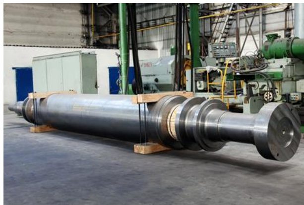
Рисунок 3.6 - «Ротор генератора» Вага: 43125кг
