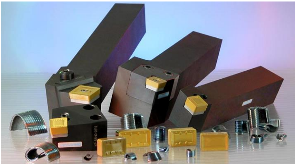
Рис. 5.5. Різальні інструменти (Pramet), що рекомендовані для обточування деталей на важких верстатах
