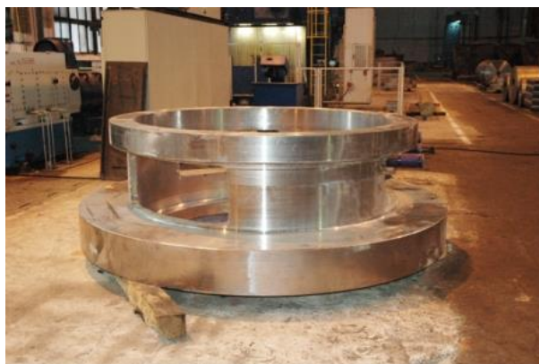
Рисунок 3.23 - Фотографія деталі «Проставка» Вага: 12800кг
