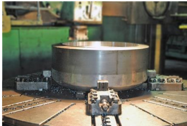
Рисунок 3.22 - Фотографія деталі «Гільза» Вага: 11614кг
