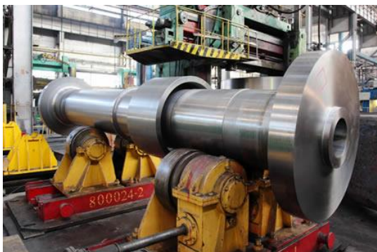
Рисунок 3.2 - «Гідровал» Вага: 17800 кг
