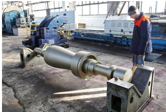
Рисунок 3.7 - «Ротор турбіни» Вага: 3225кг
