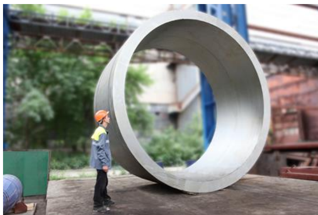
Рисунок 3.1 - «Обечайка» Вага: 62300 кг
