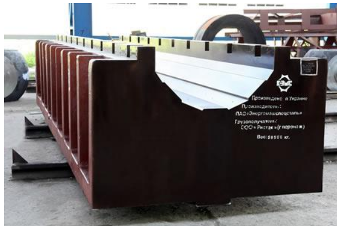
Рисунок 2.10 - «Корпус штампа верхній» Вага: 58500 кг
