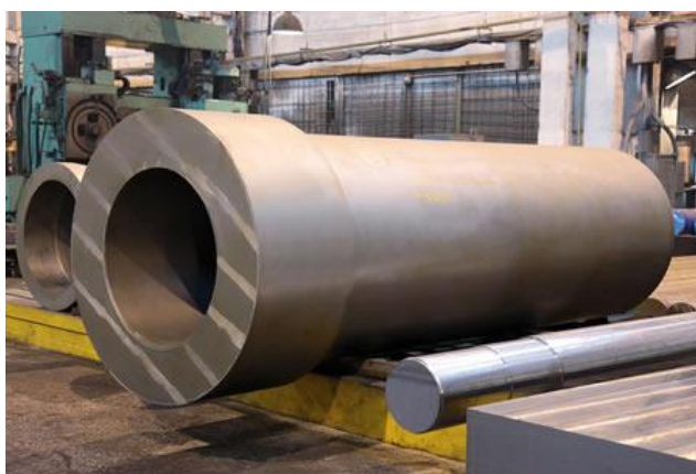
Рисунок 3.3 - «Корпус колектора» Вага: 19800 кг Марка сталі: 10ГН2МФА-А
