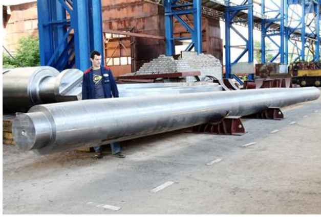
Рисунок 3.13 - «Баллер керма» Вага: 37105 кг
