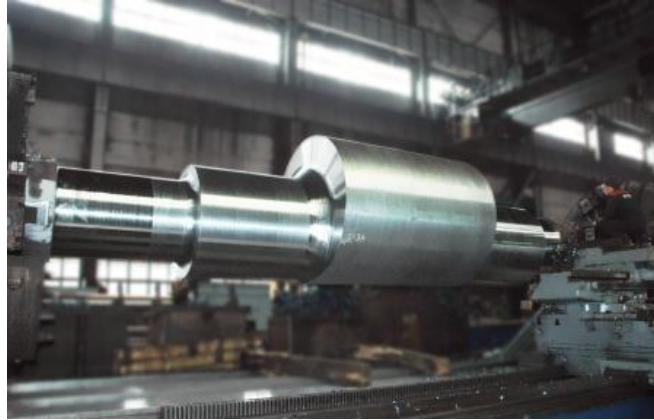
Рисунок 3.19 - «Вал ексцентрик» Вага: 81000кг
