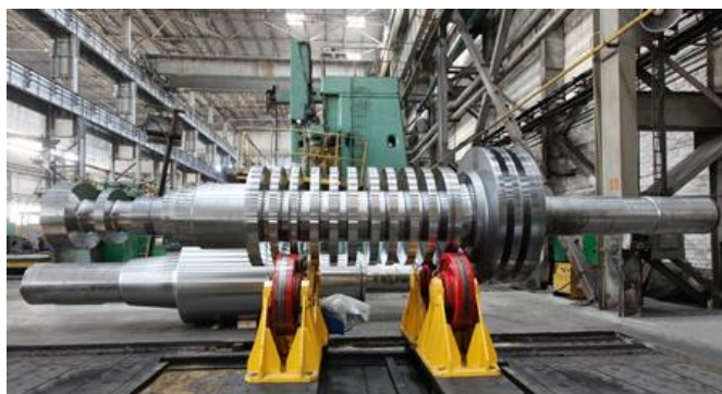
Рисунок 3.4 - Фотографія деталі «Ротор» Вага: 26100 кг
