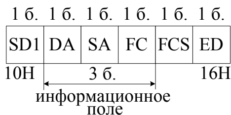
Рис. 4.1. Формат телеграммы с постоянной длиной информационного поля: DA – адрес назначения; SA – адрес источника; FC – идентификатор службы; FCS – контрольная сумма; ED – окончание пакета.
