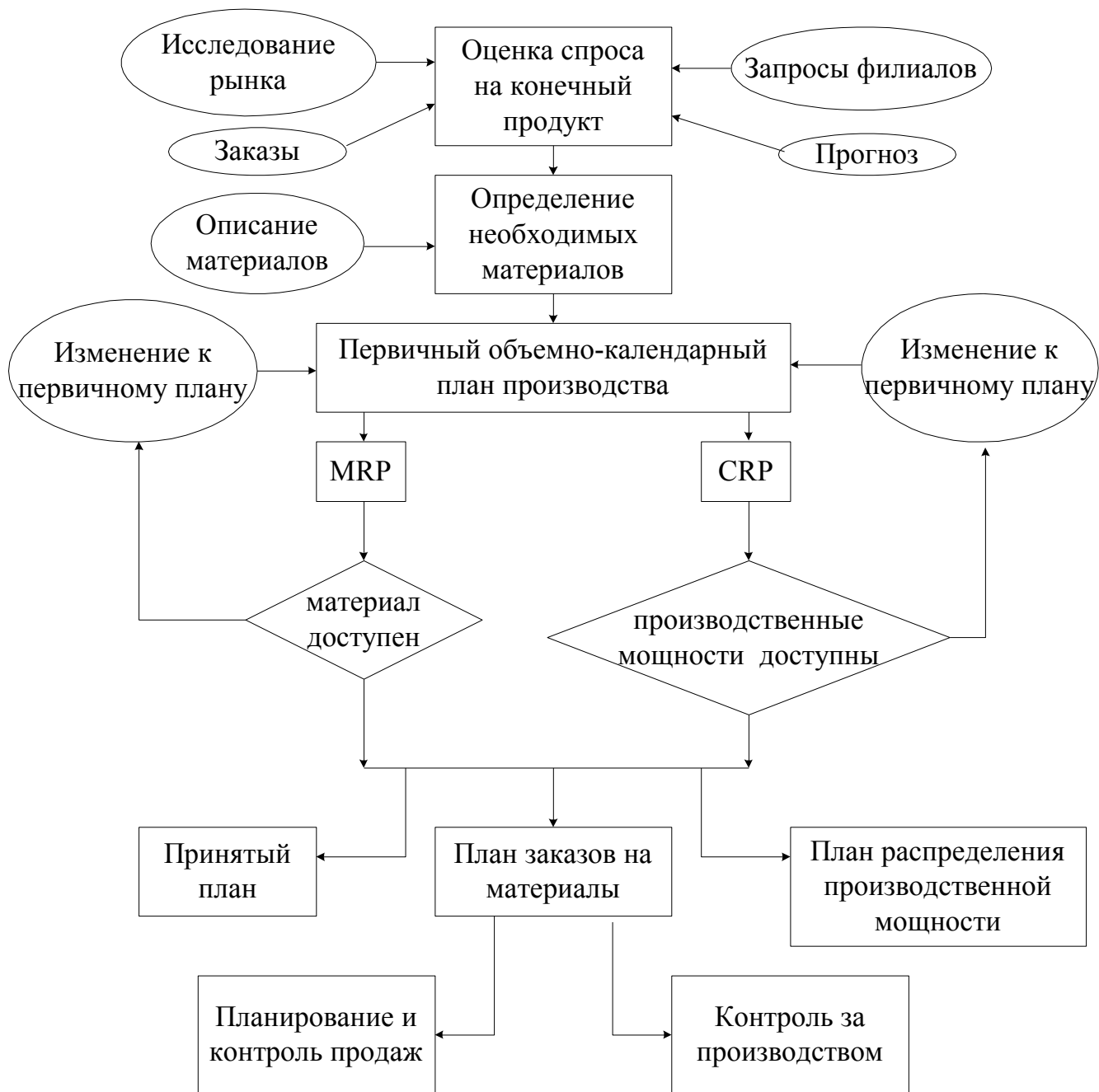
Рис. 7.1. Структура ERP: CRP – планирование производственных мощностей.
