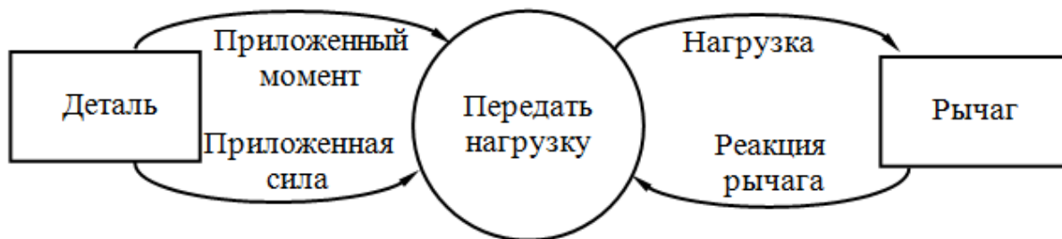
Рисунок 3.9 – Граф функционального описания объекта
