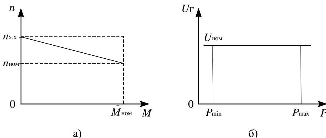
Рис. 4.2. Статическое (а) и астатическое (б) управление при изменении нагрузки
