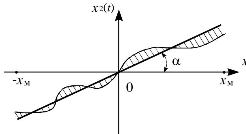
Рис. 6.4. Нелинейная характеристика и ее линейная аппроксимация
