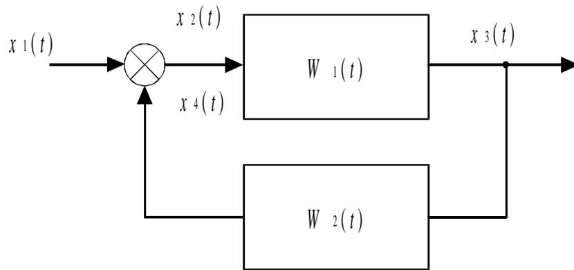
Рис. 7.9. Соединение с обратной связью
