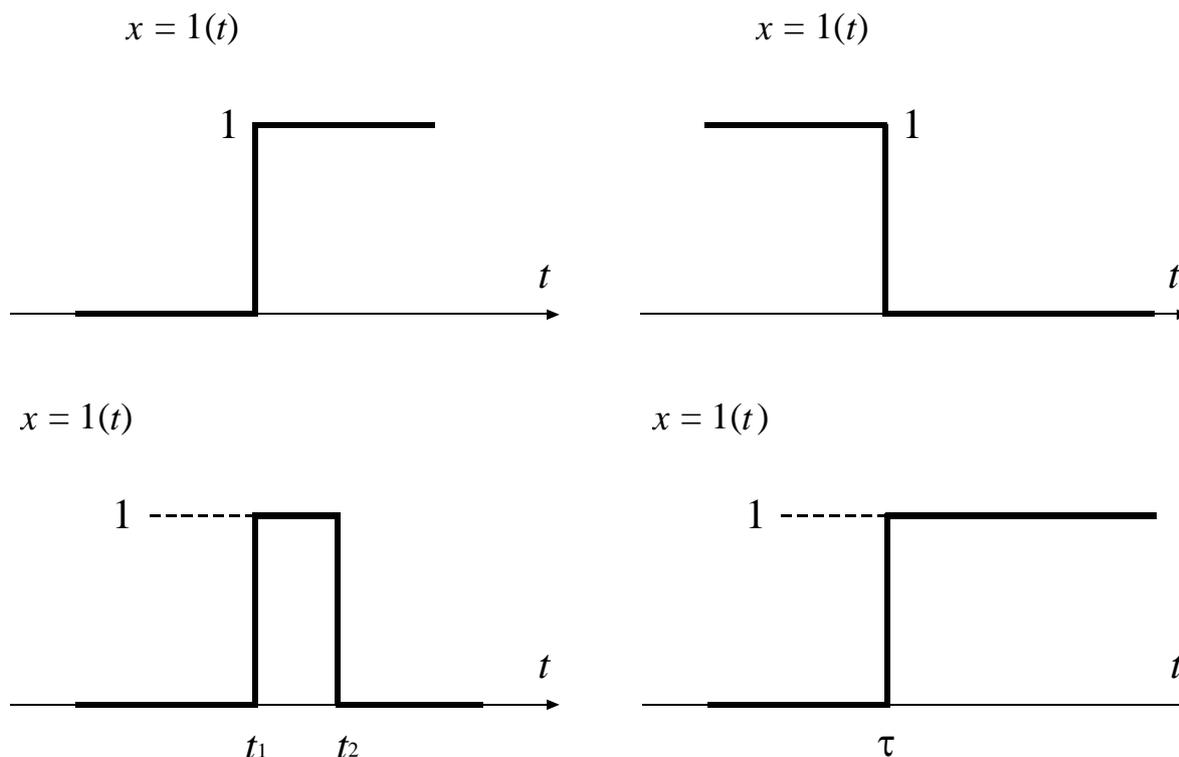
Рис. 8.1. Виды единичной ступенчатой функции
