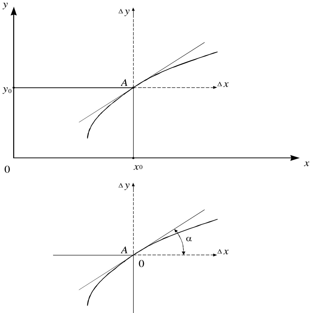
Рис. 6.5. Линеаризация по методу малых отклонений
