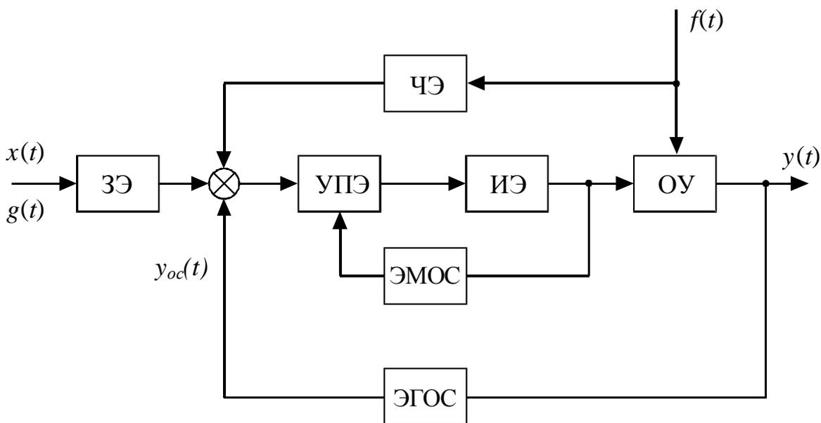
Рис. 3.3. Типовая функциональная схема САУ
