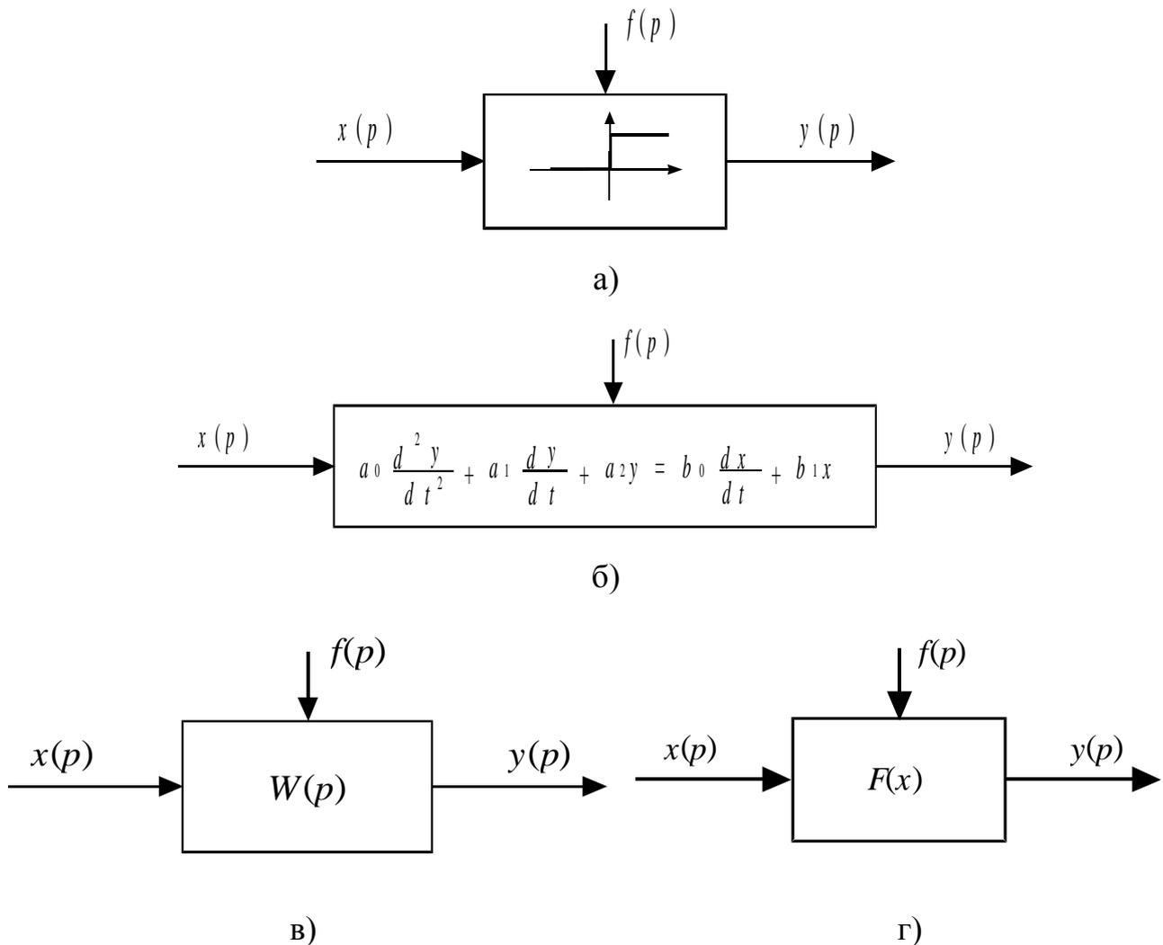
Рис. 7.4. Динамические звенья: а) с характеристикой в виде графической зависимости; б) с характеристикой в виде дифференциального уравнения; в) с характеристикой в виде передаточной функции; г) с характеристикой в виде обычной функции
