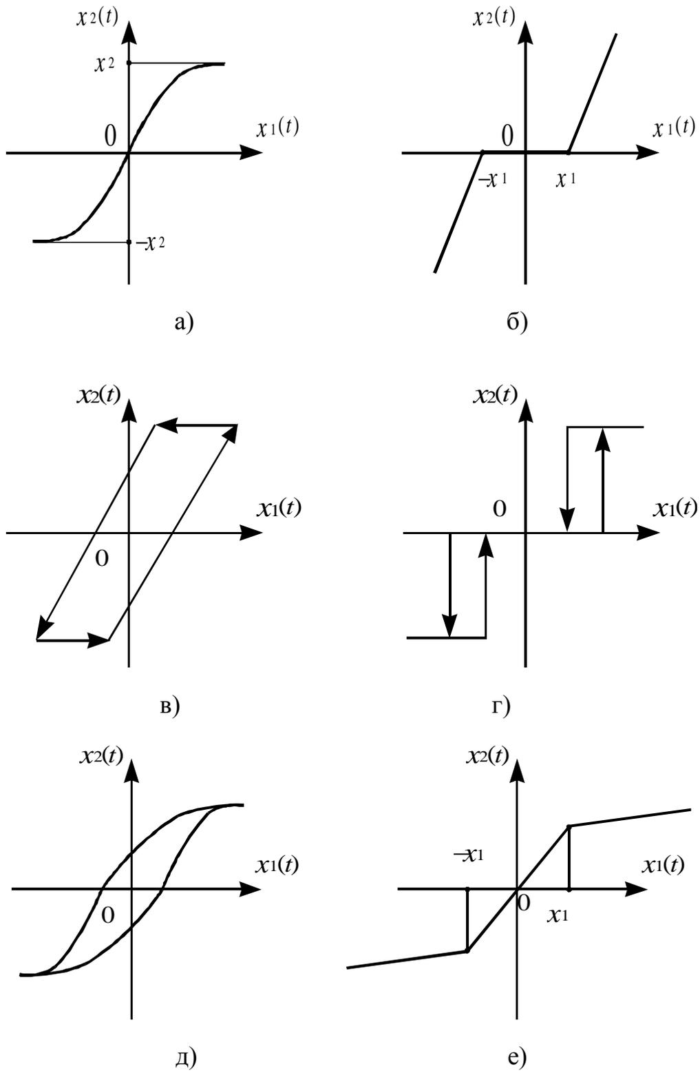
Рис. 6.3. Примеры нелинейных характеристик: а) однозначная, типа насыщения; б) с зоной нечувствительности; в) неоднозначная, типа петля люфта; г) релейная, с зоной нечувствительности и зонами неоднозначности; д) петля гистерезиса; е) кусочнолинейная аппроксимация.
