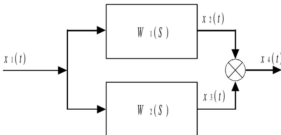
Рис. 8.8. Параллельное соединение звеньев
