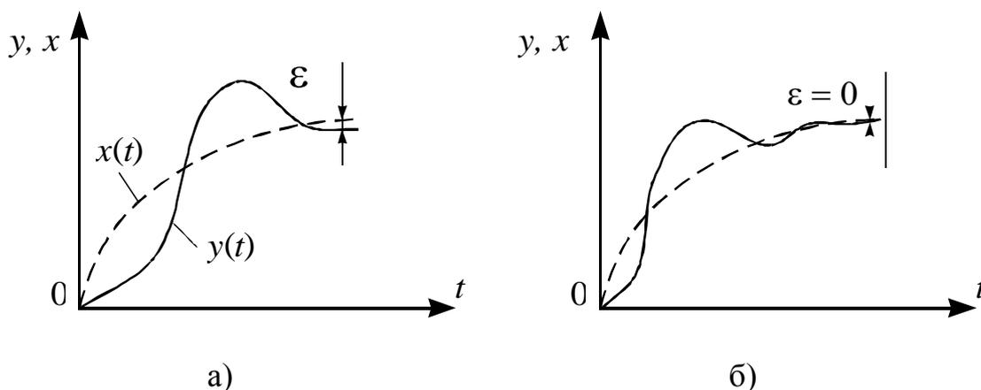
Рис. 4.1. Статическое (а) и астатическое (б) управление
