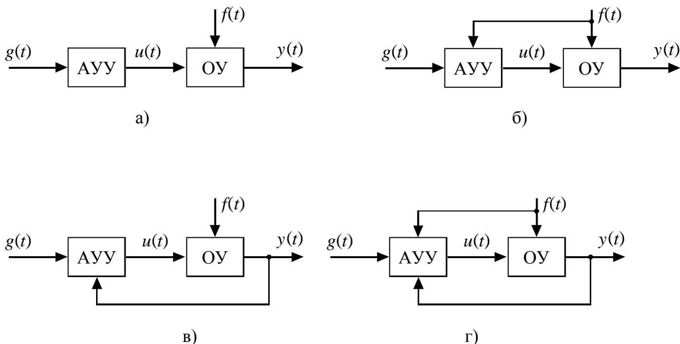
Рис. 3.4. Принципы управления: а) управление по задающему воздействию; б) управление по возмущению; в) управление по отклонению; г) комбинированное управление
