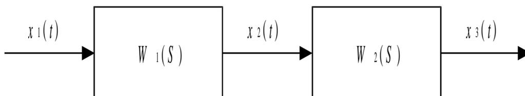
Рис. 7.7. Последовательное соединение звеньев
