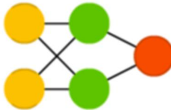
Рисунок 2.23 – Перцептрон, архітектура НМ для класифікації образів
